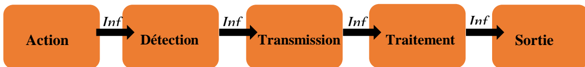
Figure 1. Schéma fonctionnel modélisant le fonctionnement du TNI et du Smartphone tactile.
