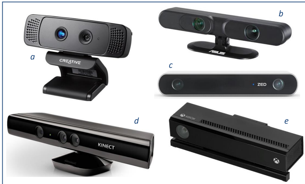
Figure 42. Quelques exemples de caméras de profondeurs. a) Creative Caméra 1 . b) Xtion Pro 2 . c) Zed 3 caméra. d) Kinect. e) Kinect 2 4 .
