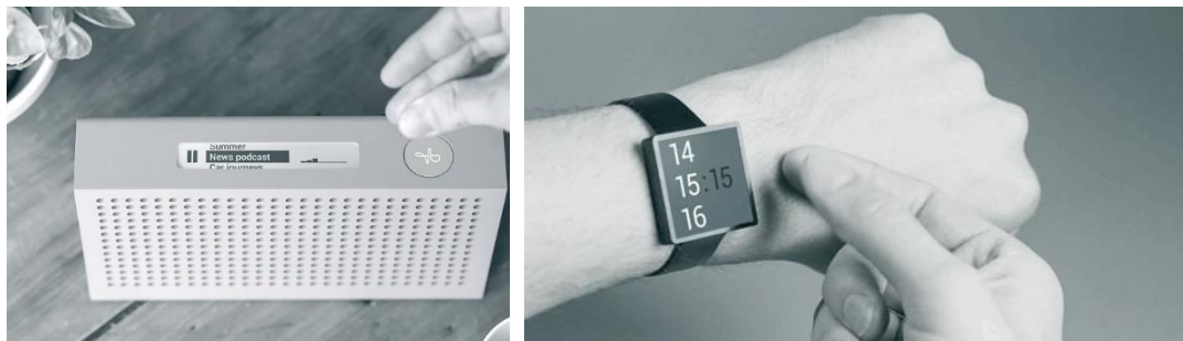
Figure 34. Interaction avec des appareils intelligents par le capteur Soli, (Lien et al. 2016).
