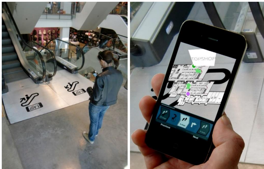
Figure 24. Application de réalité augmentée avec monde en miniature pour la navigation en intérieur (Mulloni et al. 2012).
