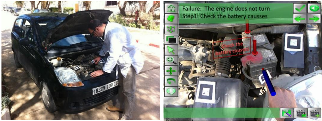
Figure 3. Un technicien utilise le système d'aide à la maintenance par la réalité augmentée proposé dans (Benbelkacem et al. 2011) pour maintenir son véhicule.
