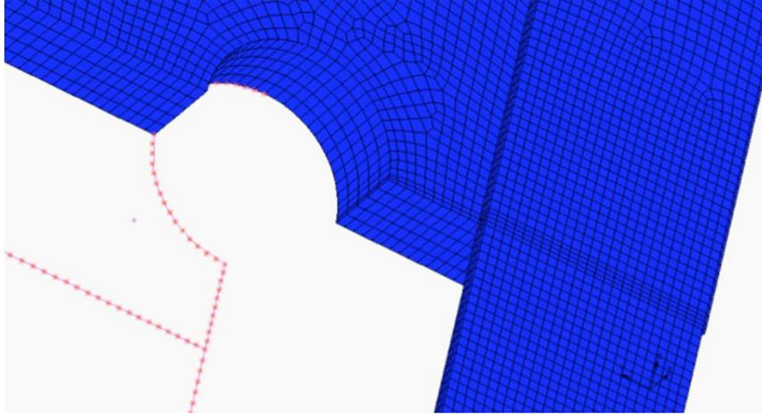
**Figure 121 :** Maillage des éléments de renforcement
