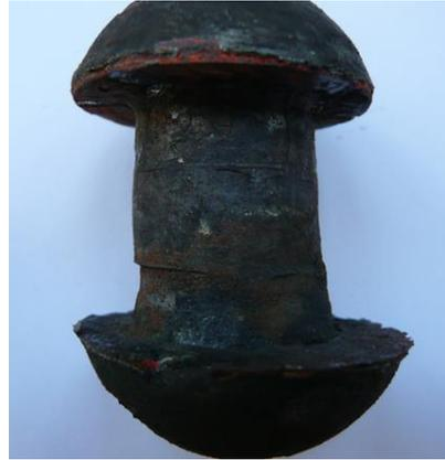
**Figure 2:** Ovalisation du perçage observée sur ouvrage riveté ancien (ouvrage de Pussy, CEREMA Lyon)
