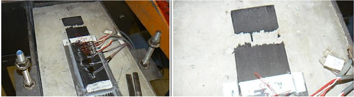
Figure 31: Rupture près des mors pour l'essai sur assemblage métal/PRFC UHM soumis à des cycles de charge/décharge
