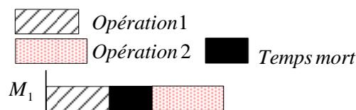
Figure II. 15 : Temps mort entre les opérations
