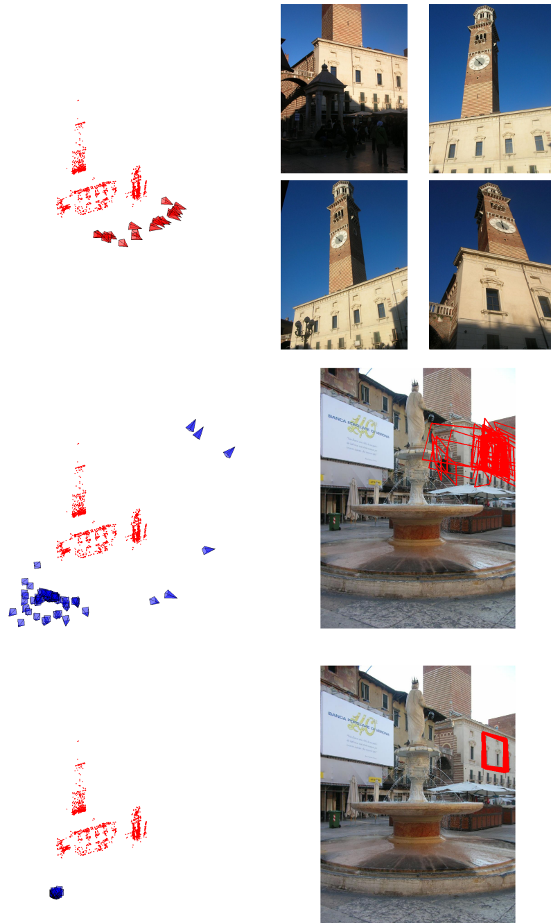
FIGURE 6.11 – Séquence tour. La première rangée montre la position des caméras de construction par rapport au modèle et un échantillon des images utilisées pour la reconstruction. La deuxième et la troisième rangée montrent les positions de caméras et les reprojctions des contours pour respectivement 100 poses calculées à partir du modèle SfM et 100 poses calculées à partir du modèle enrichi par synthèse de vues.
