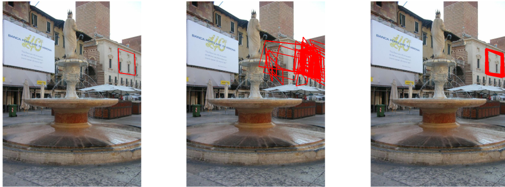
FIGURE 1.4 – La projection de quelques contours de la scène permet d'illustrer la précision des poses calculées. L'image de gauche montre le cadre de référence. L'image du milieu montre les contours projetés avec des caméras estimées sans utiliser de vues de synthèse. L'image de droite montre les contours projetés avec des caméras estimées en utilisant de vues de synthèse. Les poses calculées présentent dans ce cas une variabilité bien plus faible, les contours projetés étant mieux localisés.
