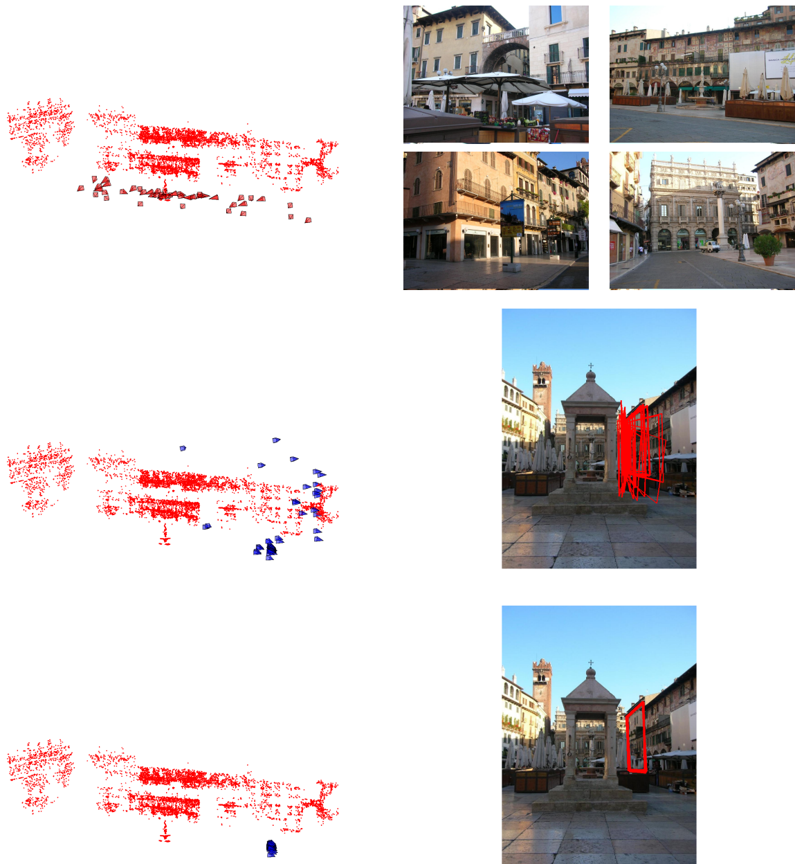
FIGURE 6.13 – Séquence place. La première rangée montre la position des caméras de construction par rapport au modèle et un échantillon des images utilisées pour la reconstruction. La deuxième et la troisième rangée montrent les positions de caméras et les reprojctions des contours pour respectivement 100 poses calculées à partir du modèle SfM et 100 poses calculées à partir du modèle enrichi par synthèse de vues.
