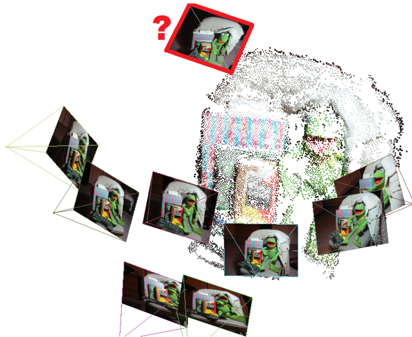
FIGURE 1.1 – Un nuage de points reconstruit à partir d'un ensemble d'images. On cherche à déterminer la pose associée à l'image encadrée en rouge et dont le point de vue est sensiblement différent des images utilisées pour construire le modèle.
