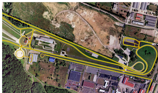
(b) Sous-partie de carte OpenDRIVE des pistes de Satory superposée à une orthophoto
