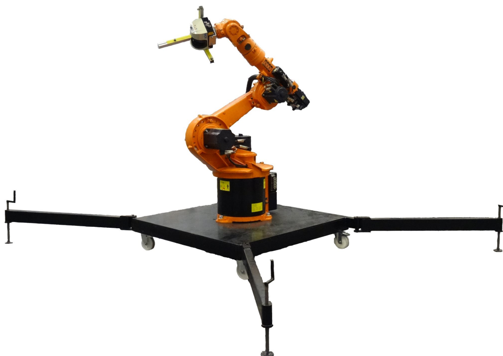
FIGURE 2.12 – Bras manipulateur Kuka sur son support mobile, servant à l'exécution de trajectoires de références à un LiDAR Sick dans le cadre du projet Navalis . Un trièdre de marqueurs Vicon monté sur le LiDAR permet de contrôler la trajectoire générée.
