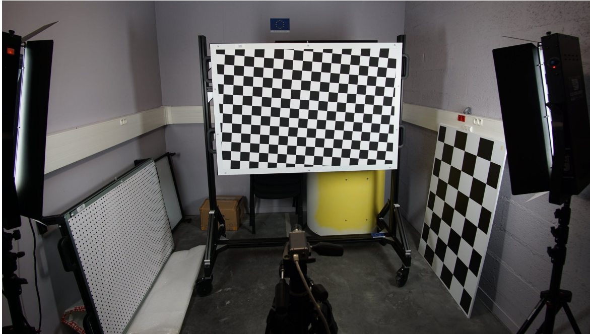
FIGURE 2.6 – Banc de calibration de caméras DXO . Les paramètres intrinsèques extraits du capteur (au premier plan) nous permettent de paramétrer le simulateur Pro-SIVIC
