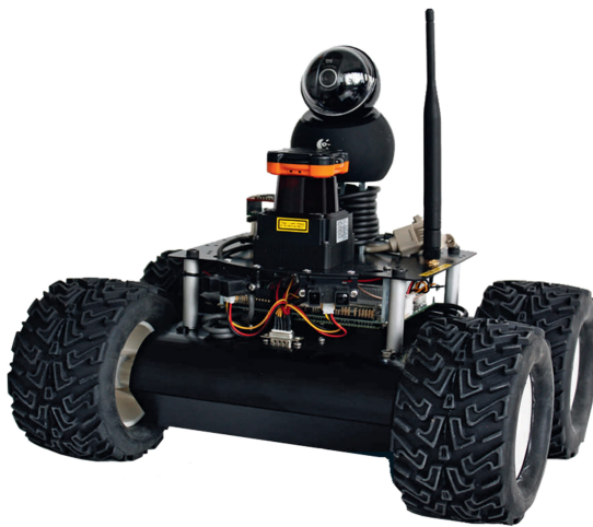
(a) Plateforme Mobile WifiBot , équipée d'un LiDAR Hokuyo UTM30LX et d'une centrale d'attitude VectorNav VN-100 .
