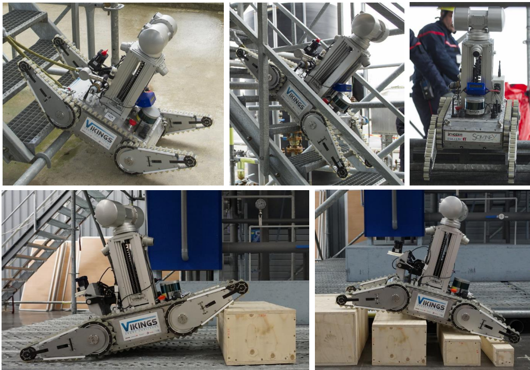
FIGURE 3.19 – Exemples de trajectoires 6D exécutées par le robot Viking, en haut négociation des escaliers sur les installations du site de la compétition, en bas franchissement d’obstacles.
