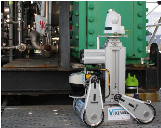
(b) Viking v1.0, compétition juin 2105 VLP16 à l'arrière LMS511 à l'avant et IMU bas coût.
