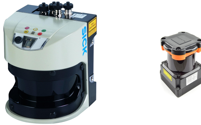
(a) LiDARs mono-nappe : à gauche Sick LMS511 80m 5 échos 190°, à droite Hokuyo UTM30-LX 30m 1 écho 270°
