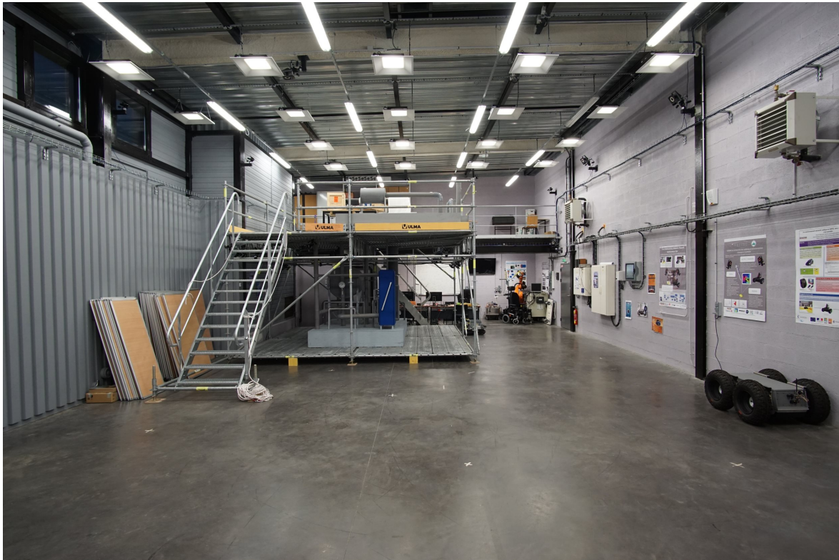
FIGURE 2.8 – Plateforme de navigation autonome en décembre 2015, équipée avec la maquette du Challenge Argos . Des panneaux d'éclairages installés au plafond permettent de contrôler les conditions lumineuses de l'environnement.
