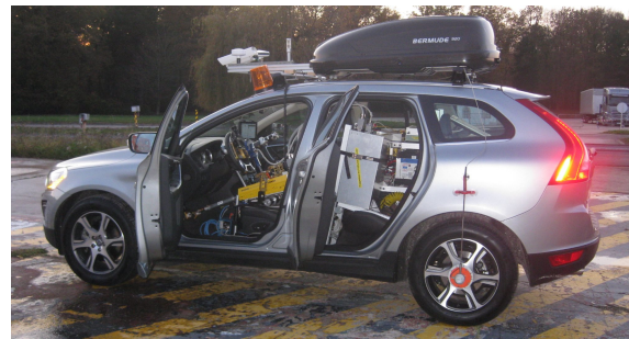
(d) Volvo XC60 ayant servi à démontrer la transposition sur un autre véhicule : coffre de toit, robot de conduite et rack de contrôle.
