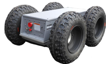
(e) Plateforme extérieure, 100kg de charge utile, Segway RMP440
