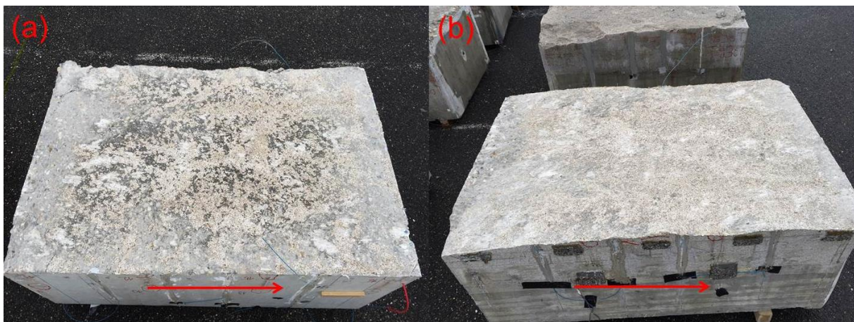
Figure 4-70 Etat des surfaces (a) du béton et (b) du granite du contact de l'éprouvette I8 après rupture
