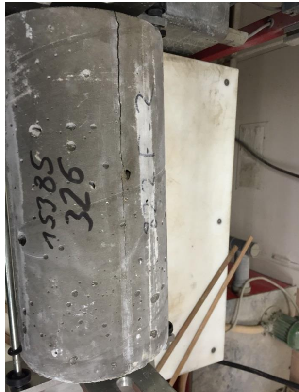
Figure 2-5 Etat d'une éprouvette de béton après un essai de fendage
