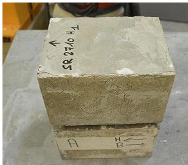
Figure 3-4 Eprouvette de cisaillement préparée à partir d'une carotte
