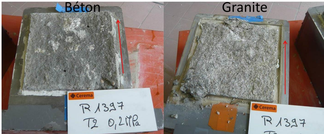
Figure D. 6 Etats des surfaces du béton et du granite après rupture
