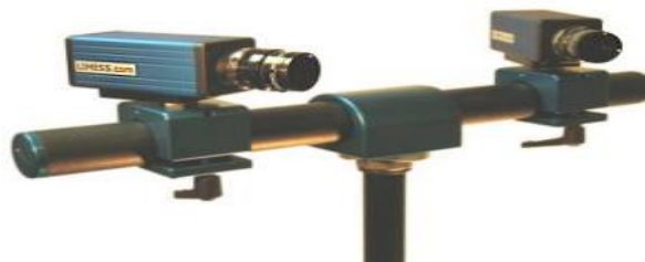
Figure 2-14 Deux capteurs CCD d'un système de stéréocorrélation d'images ( www.dantecdynamics.com )
