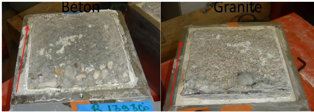
Figure D. 27 Etats des surfaces du béton et du granite après rupture
