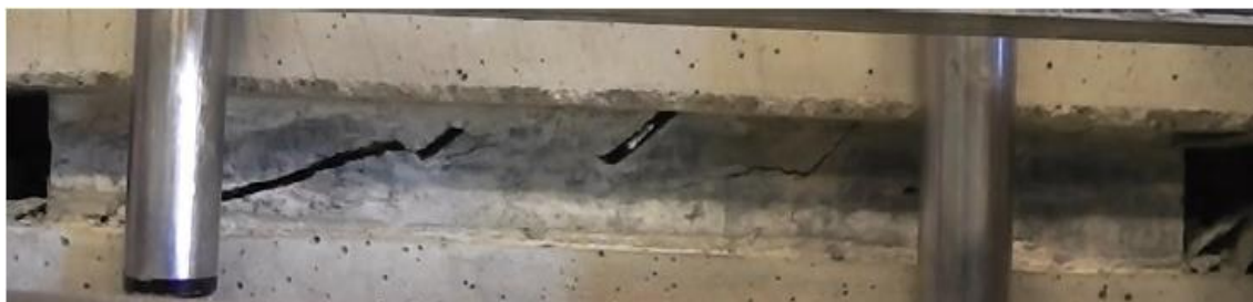
Figure 1-17 Etat de l'interface béton-roche non liée (aspérités à 40° sous \sigma_n=2,2 MPa) après essai de cisaillement (Gutiérrez 2013)
