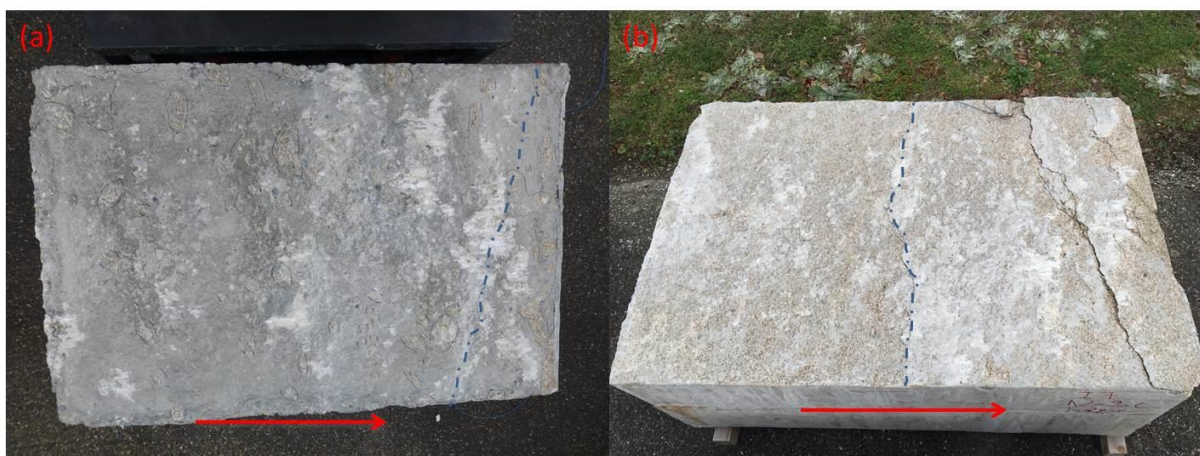
Figure 4-30 Etats des surfaces (a) du béton et (b) du granite du contact de l'éprouvette I7 après rupture
