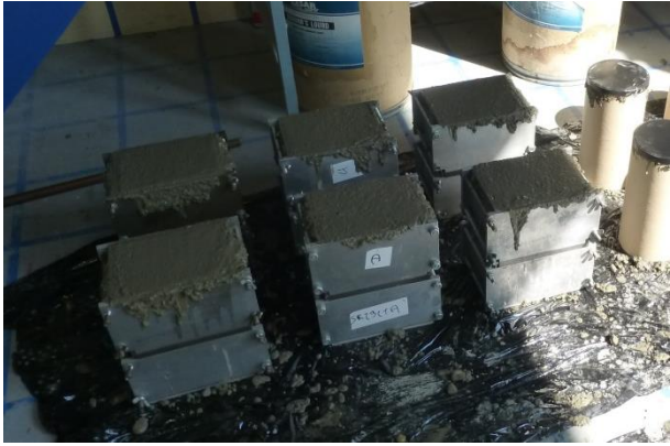
Figure 3-6 Coulage du béton des 6 éprouvettes à l'échelle intermédiaire - 1
