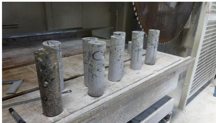
Figure 3-3 Les éprouvettes carottées après reprise des surfaces
