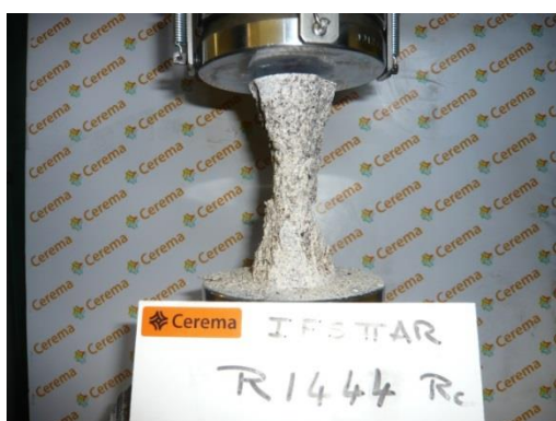
Figure 2-7 Etat d'une éprouvette du granite après un essai de compression directe
