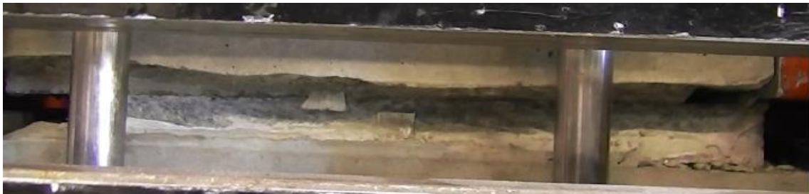
Figure 1-15 Etat de l'interface béton-roche non liée (surface lisse) après essai de cisaillement (Gutiérrez 2013)
