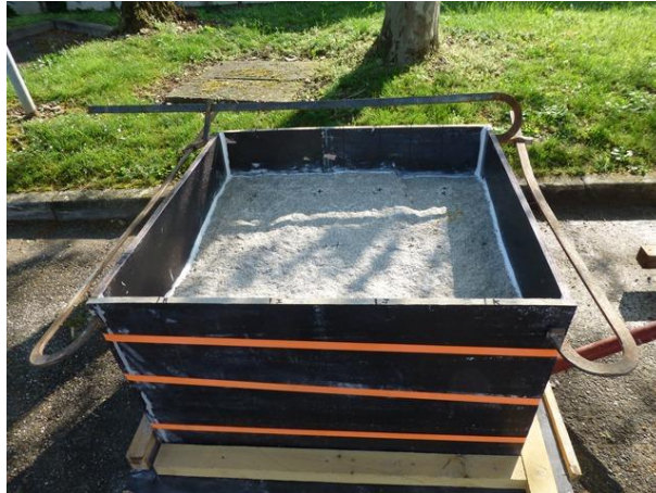
Figure 2-20 Bloc rocheux coffré destiné aux essais de traction directe
