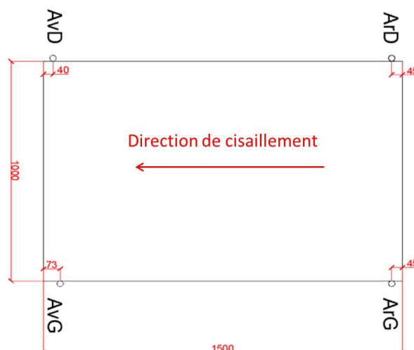
Figure 4-20 Emplacement des capteurs pour les déplacements normaux (les distances entre les arêtes verticales de l'éprouvette et les positions des capteurs sont exprimées en mm)
