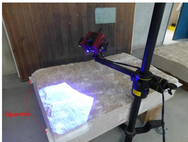
Figure 3-16 Digitalisation du grand bloc rocheux et des 4 équerres
