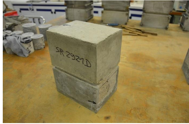
Figure 3-7 Eprouvette à l'échelle intermédiaire - 1 prête pour l'essai du cisaillement
