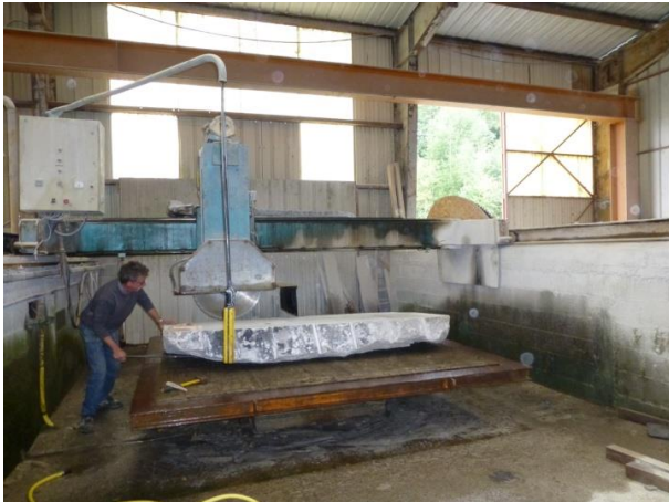
Figure 3-14 Découpe latérale d'un bloc rocheux
