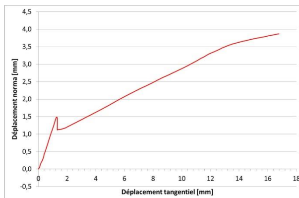
Figure D. 2 Evolution du déplacement normal en fonction du déplacement tangentiel
