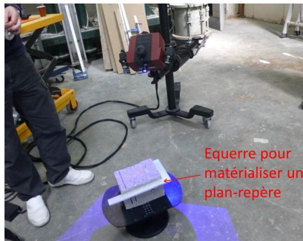
Figure 3-5 Digitalisation du bloc rocheux rectangulaire à l'échelle intermédiaire - 1
