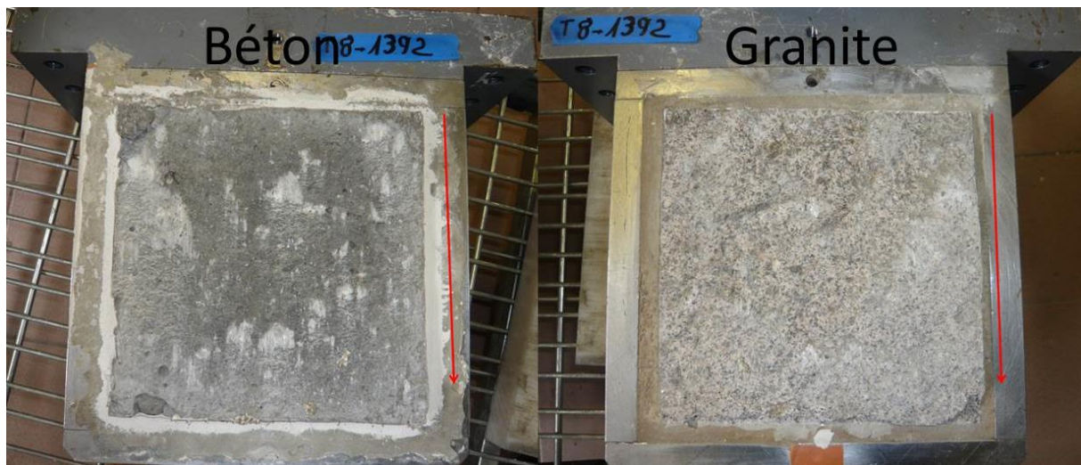
Figure 4-7 Etats des surfaces du béton et du granite du contact de l'éprouvette T8 après rupture. La direction de cisaillement est indiquée par la flèche rouge
