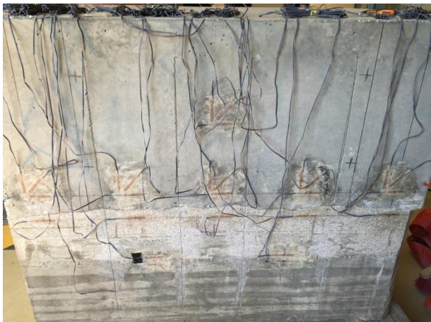
Figure 3-29 Collage des jauges de déformation sur une face latérale de la grande éprouvette
