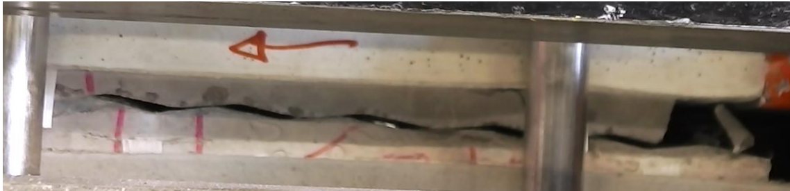
Figure 1-12 Etat de l'interface béton-roche non liée (aspérités à 10°) après essai de cisaillement (Gutiérrez 2013)
