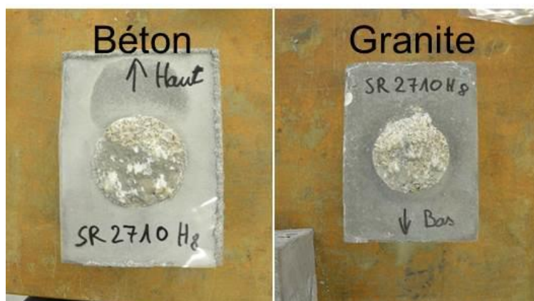
Figure 4-2 Les états des surfaces du béton et granite de la carotte H8 après rupture
