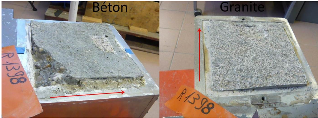
Figure D. 9 Etats des surfaces du béton et du granite après rupture
