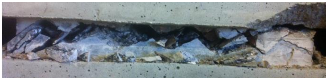
Figure 1-16 Etat de l'interface béton-roche liée (aspérités à 40° sous \sigma_n=1,2 MPa) après essai de cisaillement (Gutiérrez 2013)
