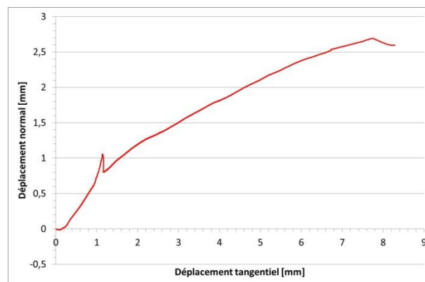
Figure B. 24 Evolution du déplacement normal en fonction du déplacement tangentiel
