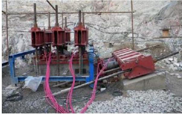
Figure 1-18 Le dispositif de cisaillement développé par Barla et al. (2011)
