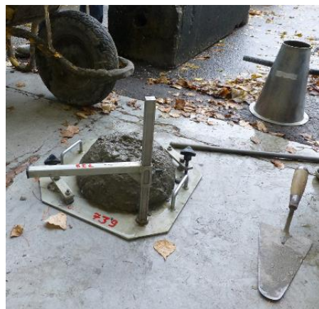
Figure 2-6 Essai d'affaissement au cône d'Abrams
