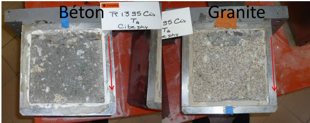
Figure D. 12 Etats des surfaces du béton et du granite après rupture
