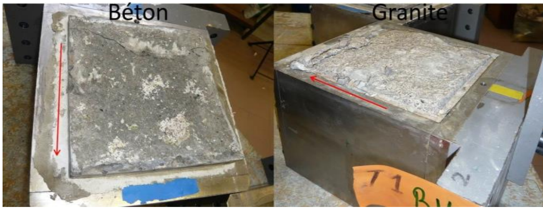
Figure D. 3 Etats des surfaces du béton et du granite après rupture
