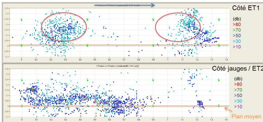
Figure 4-59 Localisation 2D des événements acoustiques cumulés durant l'essai sur les deux faces latérales de l'éprouvette I1 sous 1MPa
