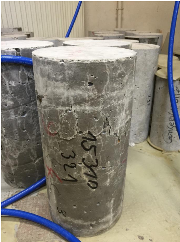
Figure 2-4 Etat d'une éprouvette de béton après un essai de compression directe
