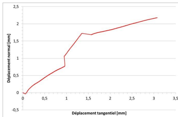
Figure B. 9 Evolution du déplacement normal en fonction du déplacement tangentiel
