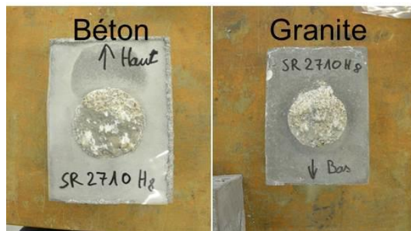
Figure A. 28 Etats des surfaces du béton et du granite après rupture
