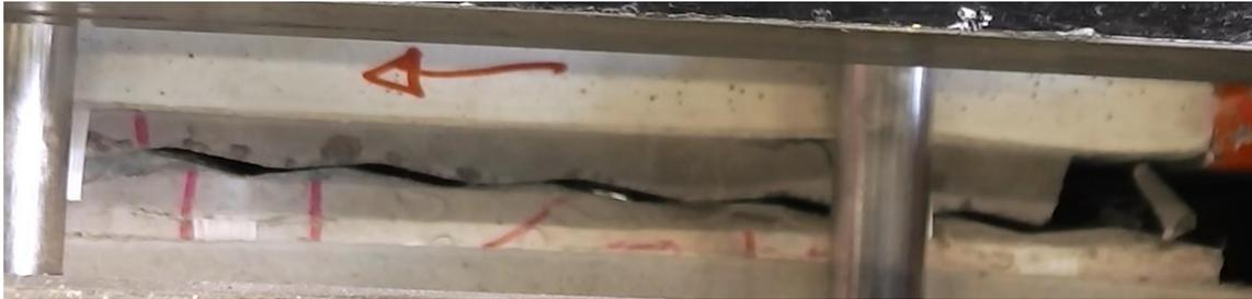
Figure 1-12 Etat de l'interface béton-roche non liée (aspérités à 10°) après essai de cisaillement (Gutiérrez 2013)
