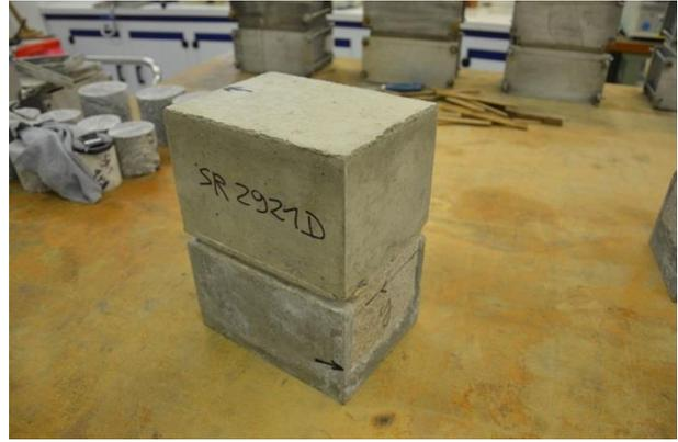
Figure 3-7 Eprouvette à l'échelle intermédiaire - 1 prête pour l'essai du cisaillement
