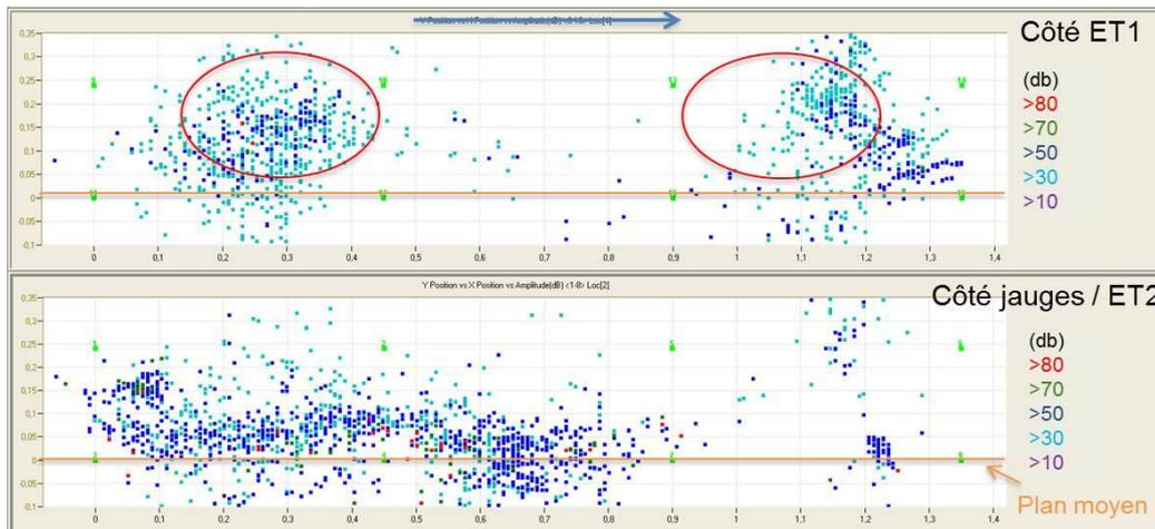
Figure 4-59 Localisation 2D des événements acoustiques cumulés durant l'essai sur les deux faces latérales de l'éprouvette I1 sous 1MPa
