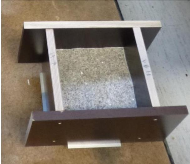
Figure 3-10 Bloc rocheux coffré
