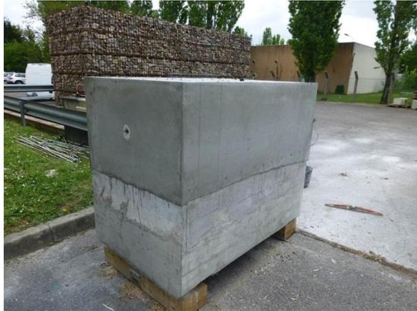
Figure 3-26 La grande éprouvette de cisaillement
