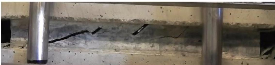
Figure 1-17 Etat de l'interface béton-roche non liée (aspérités à 40° sous  $\sigma_n=2,2$  MPa) après essai de cisaillement (Gutiérrez 2013)
