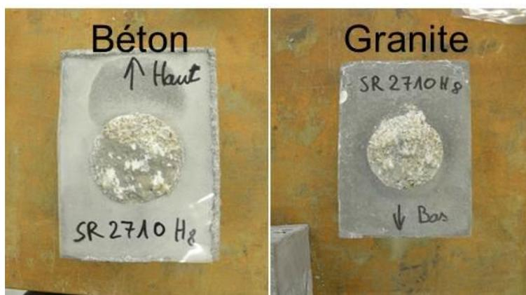
Figure 4-2 Les états des surfaces du béton et granite de la carotte H8 après rupture
