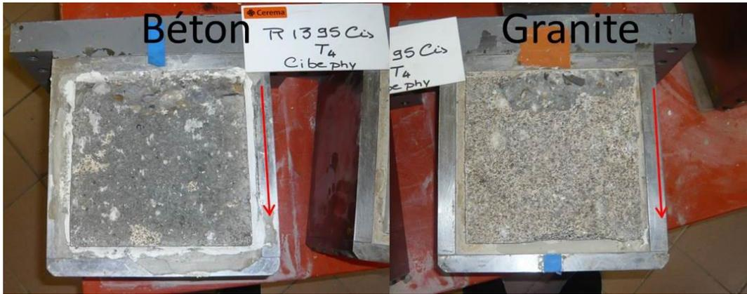
Figure D. 12 Etats des surfaces du béton et du granite après rupture
