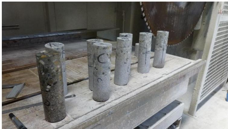
Figure 3-3 Les éprouvettes carottées après reprise des surfaces
