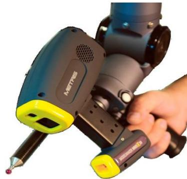
Figure 2-13 Profilomètre laser NIKON (<http://www.directindustry.fr/>)
