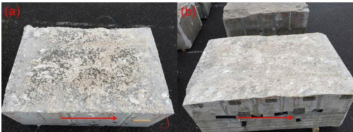
Figure 4-70 Etat des surfaces (a) du béton et (b) du granite du contact de l'éprouvette I8 après rupture
