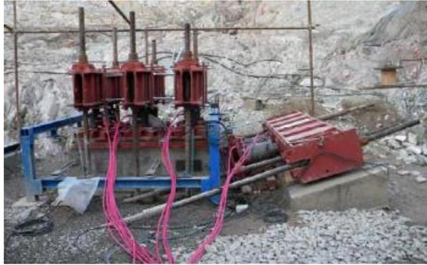
Figure 1-18 Le dispositif de cisaillement développé par Barla et al. (2011)
