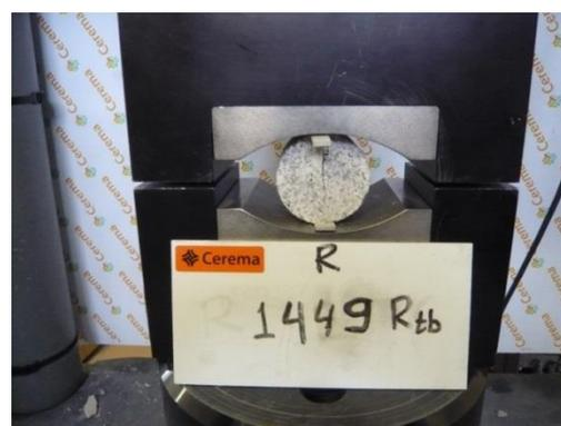
Figure 2-8 Etat d'une éprouvette du granite après un essai brésilien
