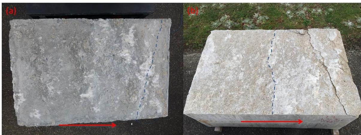
Figure 4-30 États des surfaces (a) du béton et (b) du granite du contact de l'éprouvette I7 après rupture
