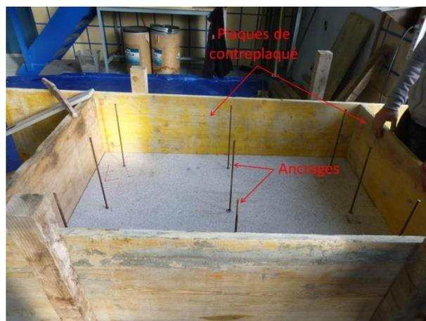
Figure 3-19 Coffrage de la partie inférieure de l'éprouvette
