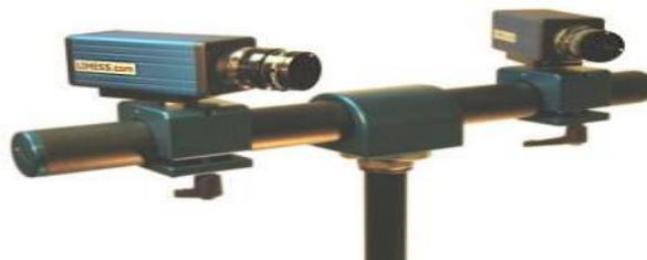
Figure 2-14 Deux capteurs CCD d'un système de stéréocorrélation d'images ([www.dantecdynamics.com](http://www.dantecdynamics.com))
