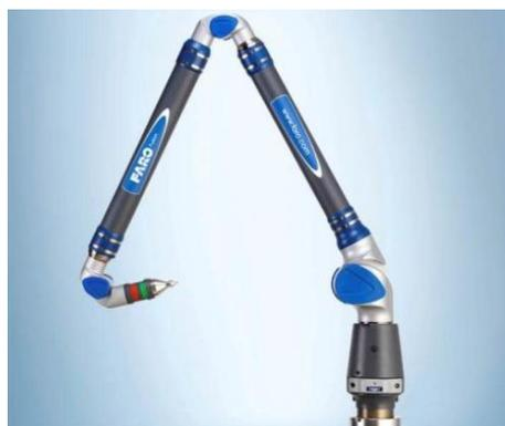
Figure 2-12 Profilomètre mécanique FARO (Rousseau 2010)
