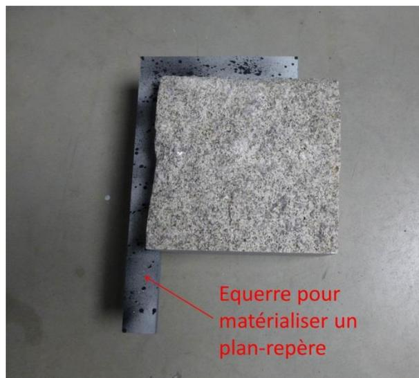
Figure 3-9 Surface rocheuse naturelle de granite à digitaliser
