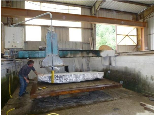
Figure 3-14 Découpe latérale d'un bloc rocheux
