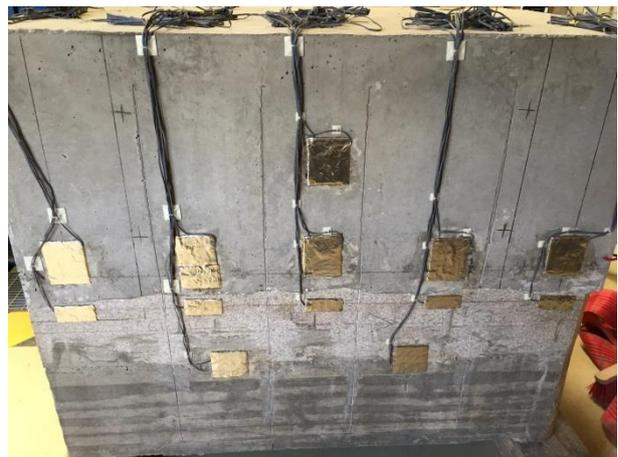
Figure 3-30 Protection des jauges
