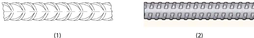
Figure 13 Différents types de barre haute adhérence (HA) (1) barre HA à verrous pour le béton armé (NF EN 10080: 2005) (2) barre HA à filetage pour les ancrages au rocher
