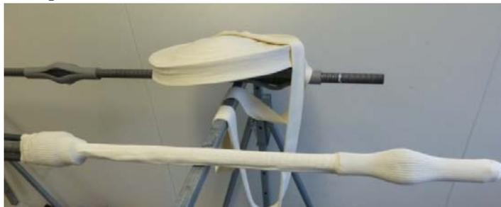
Figure 176 Barre d'ancrage équipée de la chaussette géotextile
