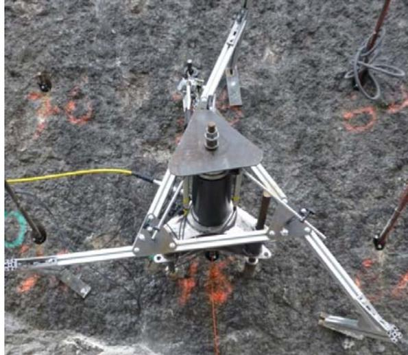
Figure 178 Le second châssis d'arrachement à empattement réduit
