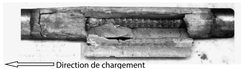
Figure 93 Rupture de l'ancrage sous une contrainte de confinement de 3,2 MPa
