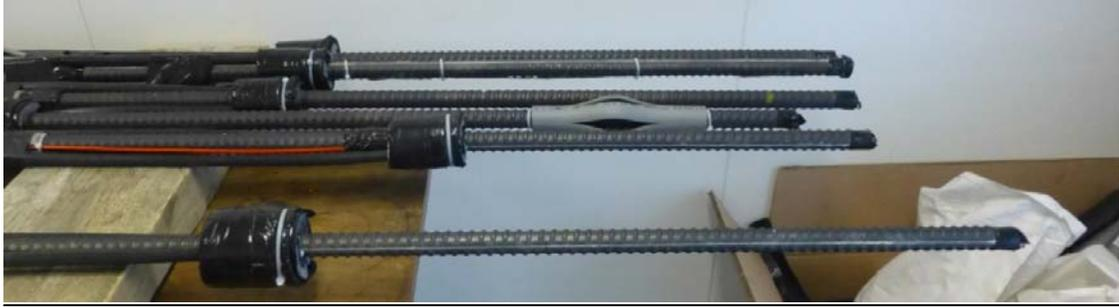
Figure 166 Barres d'acier équipées
