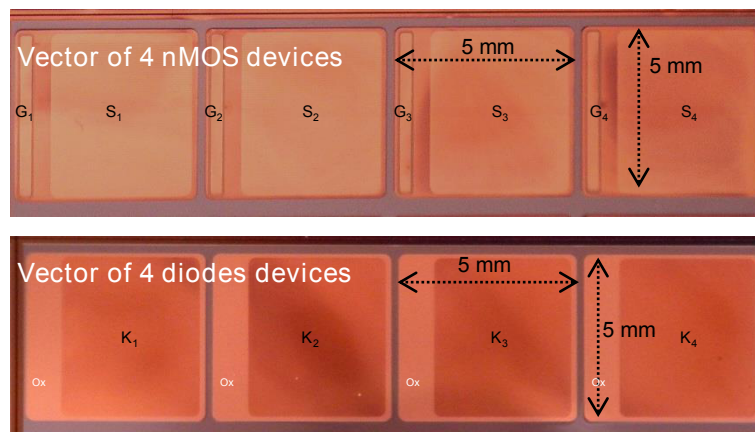
Fig. 2.29 – Zoom sur la face avant des composants dans un vecteur à quatre phases ; en haut : vue des transistors nMOS verticaux avec le large plot de grille ( 300 \mu\text{m} ) ; en bas : vue des diodes verticales avec la zone d'oxyde
