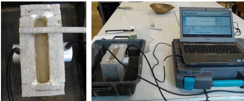
Figure V.31 : Dispositif de mesure ultra sonore par transmission directe. A gauche le récipient en mousse contenant la pâte. A droite, le système d'acquisition relié au transmetteur et au récepteur.
