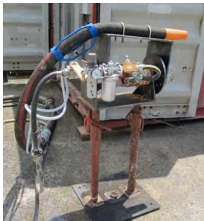
Figure II.7 : Excentrique utilisé pour imposer un mouvement circulaire à la lance
