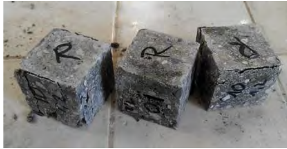
Figure II.11 : Cubes 50x50mm découpés dans les panneaux de béton projeté, après essais de résistance à la compression
