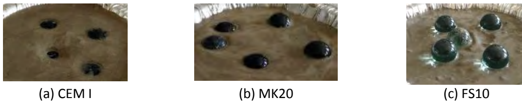
Figure V.27 : Enfoncement des billes après test de chute de bille dans le mortier CEM I(a), MK20 (b), FS10 (c)
