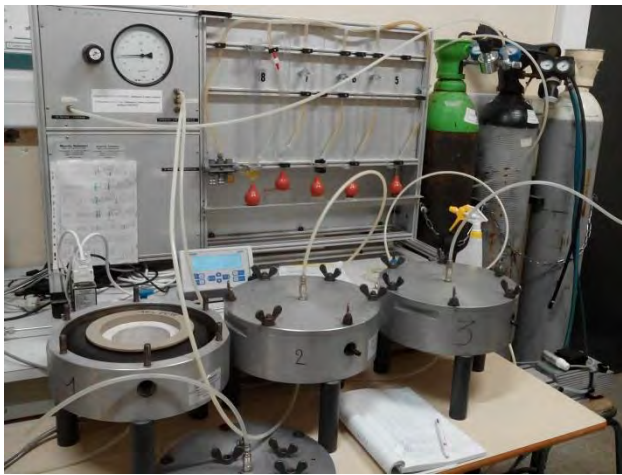
Figure II.15(a) : Cellules de mise sous vide pour la mesure de la perméabilité à l'air
