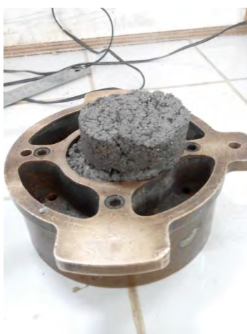
Figure A9.3 : boîte de Casagrande après cisaillement
