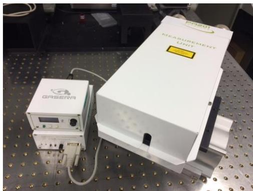
*Figure 5.7 – Photographie de la cellule photoacoustique GASERA PA 201. La cellule avec son système d'interférométrie optique pour la détection de l'onde acoustique sont situés dans le boîtier à droite et les contrôleurs de la pression et de la température de la cellule sont disposés à gauche.*
