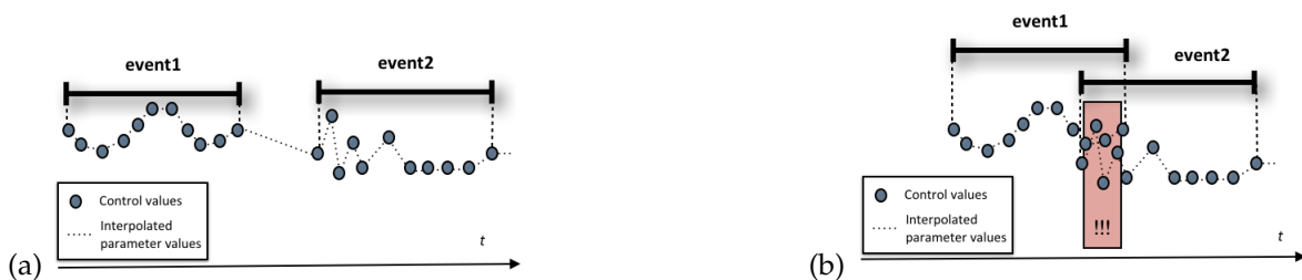
FIGURE 5.7: Représentation schématique de deux évènements OM-CHANT :valeurs de contrôle et fonctions f_p(t) ré-échantillonnées (a) sans superposition et (b) avec superposition.
