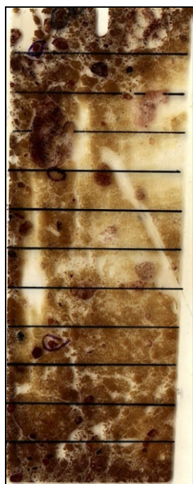
Figure 69 : Exemple de lame mince avec une grille pour les comptages micromorphologiques.
