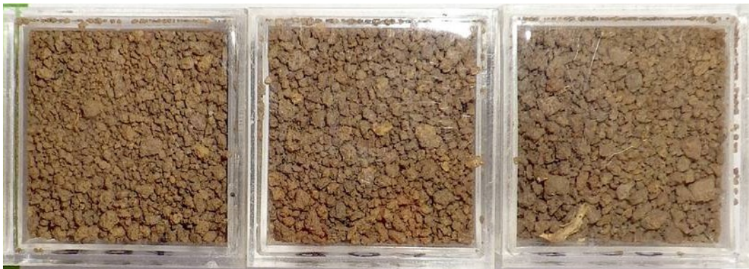
Figure 75 : Exemple des sédiments en vrac mis dans les boîtes en plastiques pour les analyses de susceptibilité magnétique, profil BAL-1.
