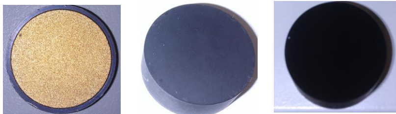
Figure 30-a : Photographie des 3 échantillons de surface : métallique lambertienne, noire doucie et noire polie (de gauche à droite)
