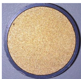
Figure 22 : Photographie de l'échantillon de surface, métallique lambertien
