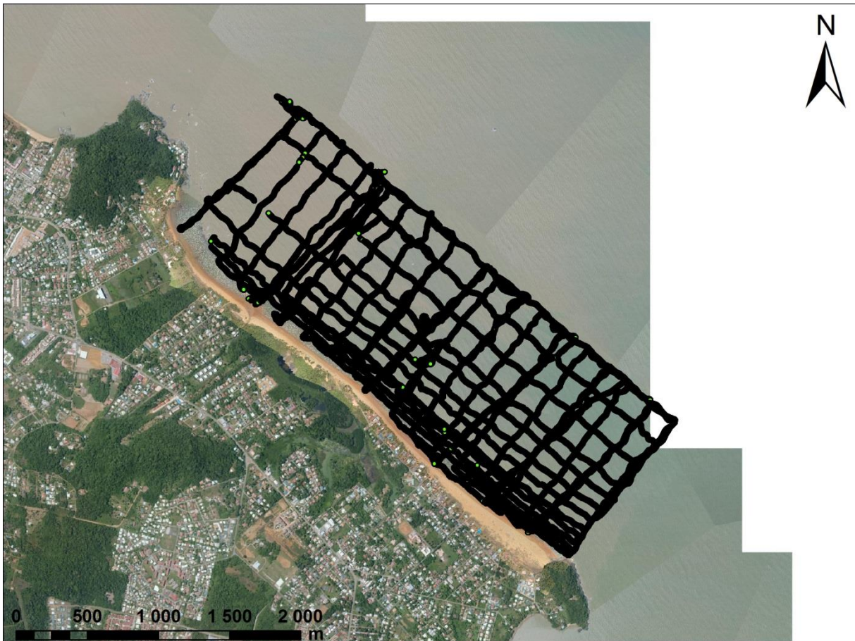
Figure 24: Données collectées après post-traitement sous Hypack 2009 sur la baie de Montjoly en octobre 2014.
