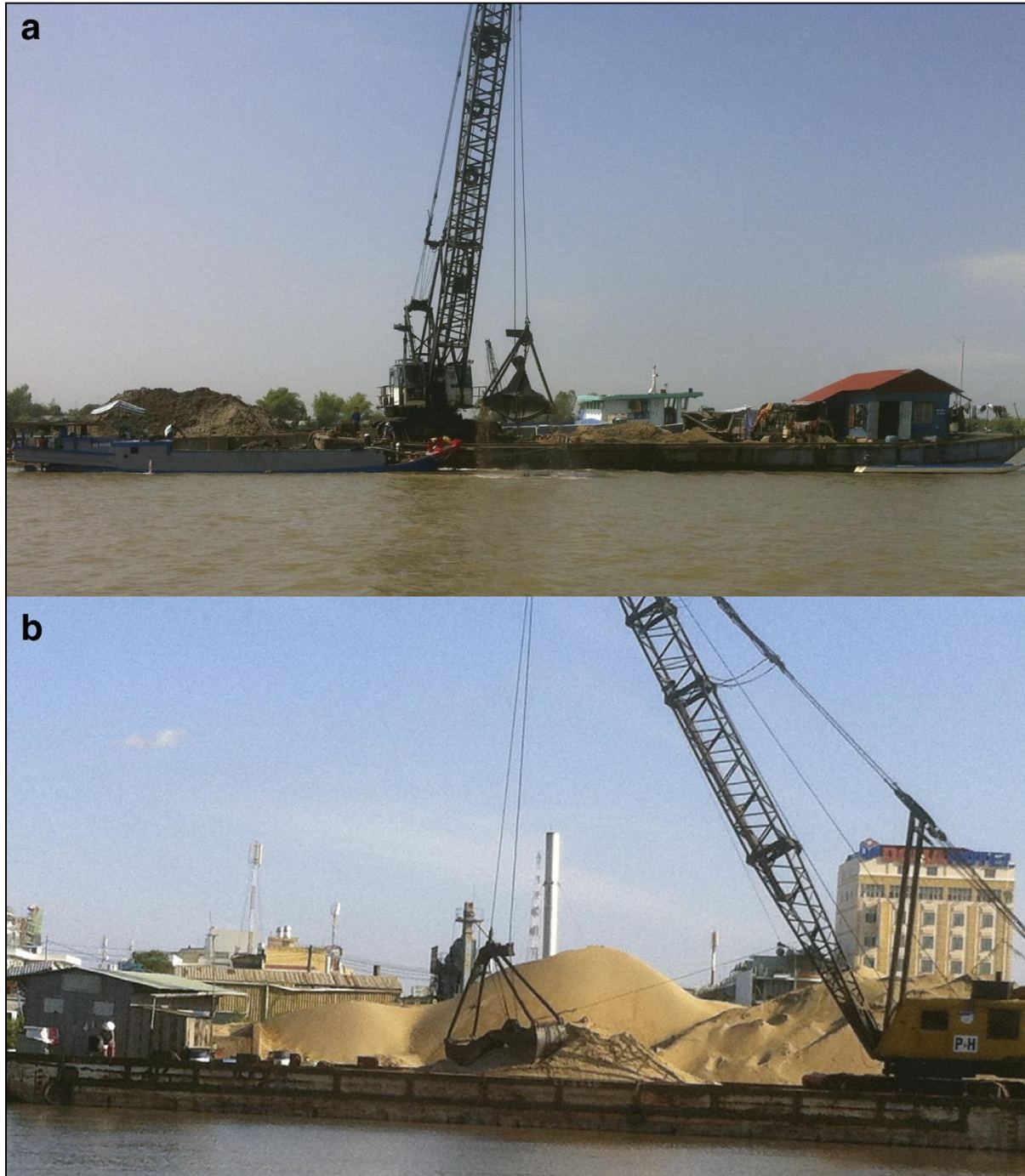
Figure 76 : Photographies de février 2012 montrant une extraction quasi industrielle des sables du Mékong dans le lit du fleuve, au niveau de Phnom Penh, Cambodge.
