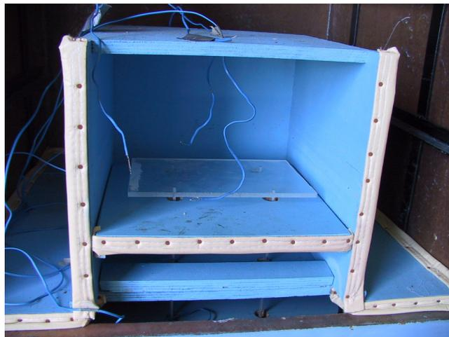
Fig. III.6 : Configuration associée à la mesure et établissement des modèles des paramètres de cinétique de séchage du produit étudié
