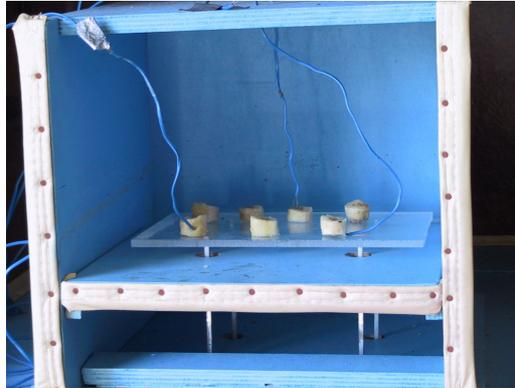
Fig.III.10: Disposition des échantillons dans le cas de banane
