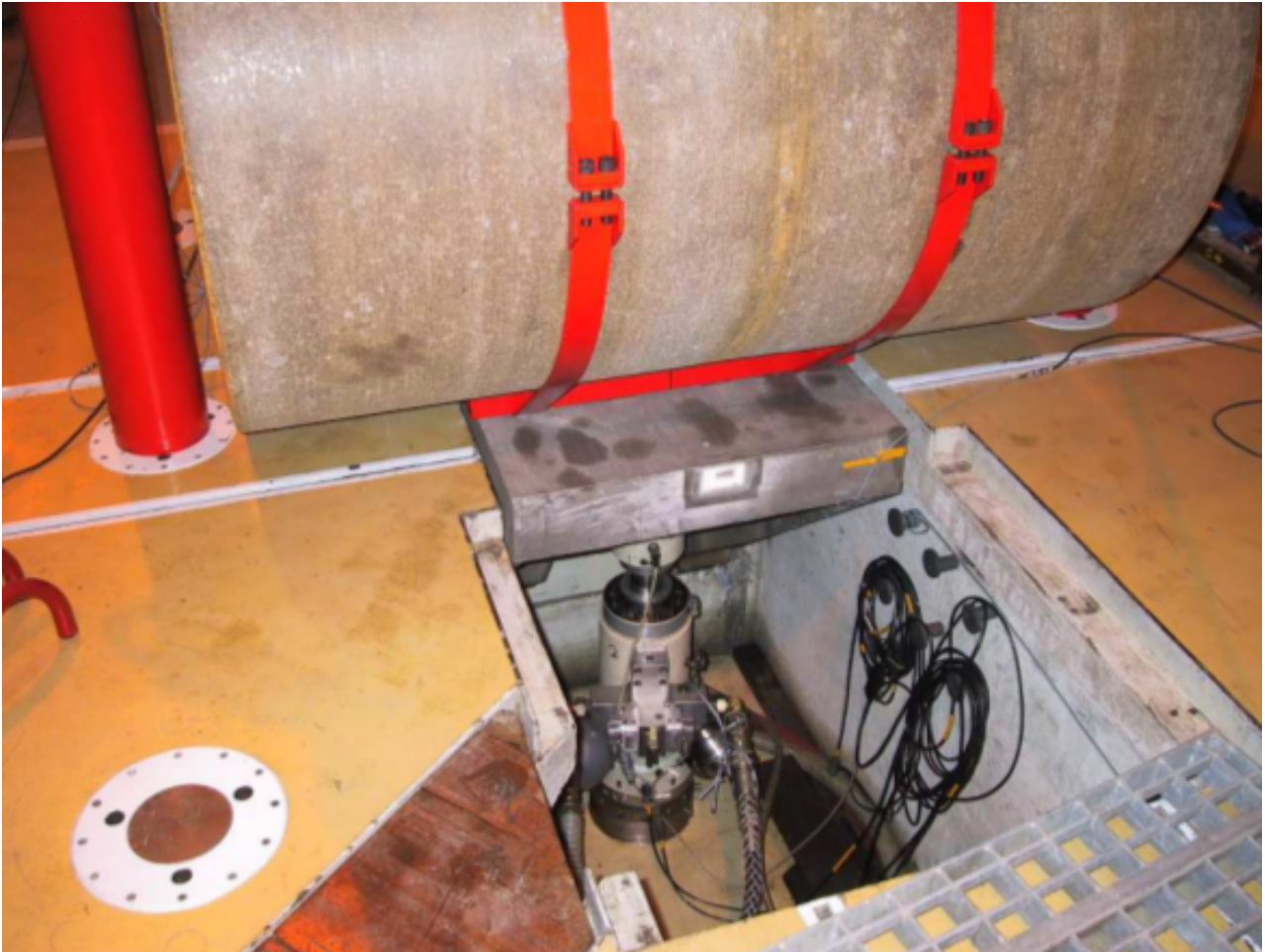
FIG. 2.4 – Servovérin de 100kN monté sous la bille du compacteur avec étrier bridé
