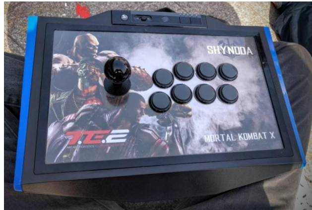
Figure 7. Stick arcade personnalisé de Shyndoa. Constitué d'un stick à « boule » pour la main gauche et de deux rangées légèrement incurvées de quatre boutons pour la main droite, le stick de Shyndoa a en plus la particularité d'être décoré aux couleurs du jeu Mortal Kombat X . (Photo provenant du terrain d'étude).
