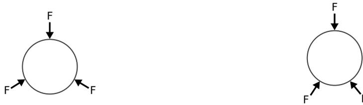
FIGURE 3.3: Exemple de deux configurations dont la moyenne des forces normales  $\bar{F}_N$  est identique, ce qui implique donc une résistance équivalente selon le modèle de Ben-Nun and Einav (2010).
