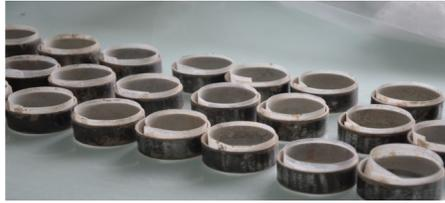
FIGURE 3.17: Moules d'acier utilisés pour la préparation des échantillons, avec les bandelettes en plastique.
