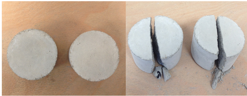
FIGURE 3.22: À gauche : échantillon avant essai. À droite : échantillons fracturés dans la configuration diamétrale.
