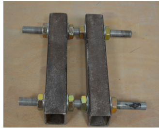
FIGURE 3.16: Dispositif multi-point permettant d'appliquer deux points de contact sur la partie inférieure de l'échantillon.
