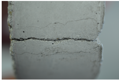
FIGURE 3.21: Surface de l'échantillon après un impact. On remarque que la zone d'impact est bien homogène.
