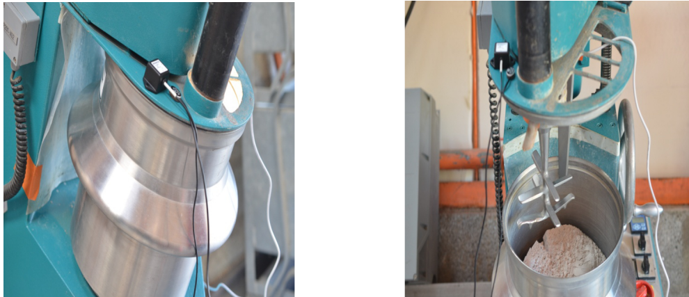
FIGURE 3.19: Malaxeur de laboratoire Eirich R02 utilisé pour le mélange des différents constituants du mortier.
