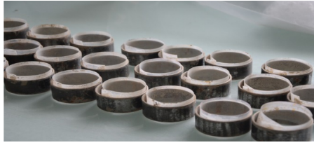
FIGURE 3.17: Moules d'acier utilisés pour la préparation des échantillons, avec les bandelettes en plastique.
