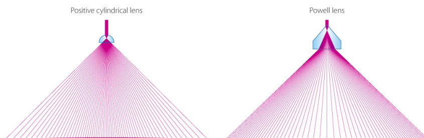
FIGURE 2.7 – Diagramme de comparaison d’une lentille cylindrique classique (gauche) avec une lentille Powell (droite). La première transmet le caractère gaussien du faisceau alors que la seconde crée un profil d’éclairage homogène. (source http://www.altechna.com )
