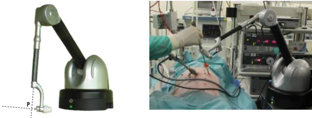
FIGURE 1.22. – Représentation du prototype Achille d'Haption
