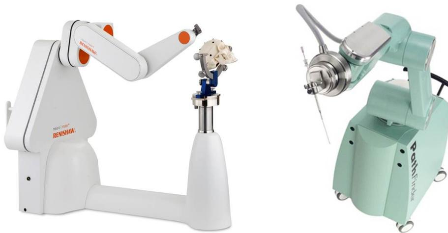
FIGURE 1.13. – **Représentation des systèmes de comanipulation Neuromate<sup>13</sup> et Path-Finder<sup>14</sup> pour la neurochirurgie**
