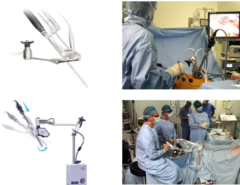
FIGURE 1.5. – Représentation des robots portes-endoscope ViKY<sup>7</sup> et FreeHand<sup>8</sup>
