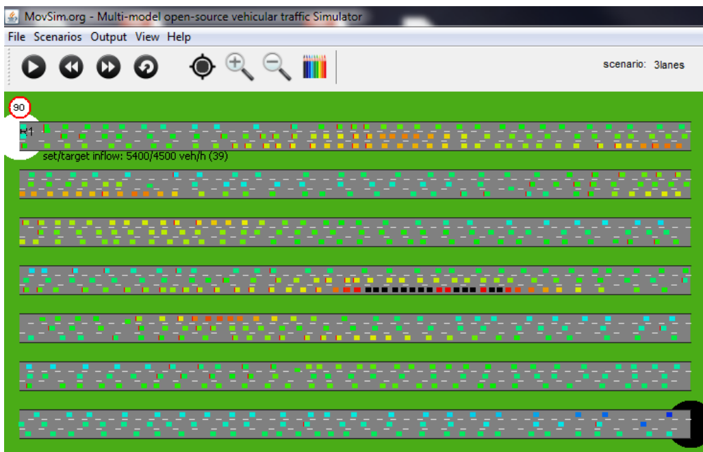
Fig. 3.12: Capture d'écran du simulateur avec le scénario de l'autoroute péri-urbaine à 3 voies pour un taux de pénétration des véhicules connectés de 20 % ( t = 3 \text{ min } 25 \text{ s} ). Le trafic évolue de gauche à droite et la section est modélisée comme continue (le saut de ligne est purement graphique). Les véhicules sont représentés par leurs vitesses, en gradient de couleur : vitesse nulle – noir ; faible vitesse – rouge ; vitesse élevée – bleu.
