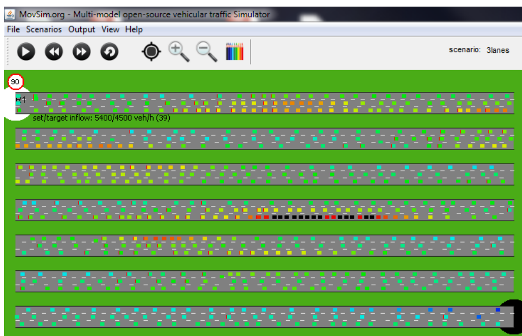
Fig. 3.12: Capture d'écran du simulateur avec le scénario de l'autoroute péri-urbaine à 3 voies pour un taux de pénétration des véhicules connectés de 20 % ( t = 3 min 25 s). Le trafic évolue de gauche à droite et la section est modélisée comme continue (le saut de ligne est purement graphique). Les véhicules sont représentés par leurs vitesses, en gradient de couleur : vitesse nulle – noir ; faible vitesse – rouge ; vitesse élevée – bleu.
