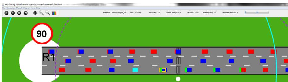
**Fig. 3.10:** Capture d'écran de la vue trafic adaptée pour le trafic coopératif dans MASCAT. Le code couleur est le même que celui de la figure 3.6. Le rectangle jaune correspond à la position du véhicule "virtuel", représentation de l'application des coefficients de proximité dans le modèle bilatéral multi-anticipatif. Les marqueurs verts sont les véhicules perçus par le véhicule courant (en cyan) dans cette configuration.
