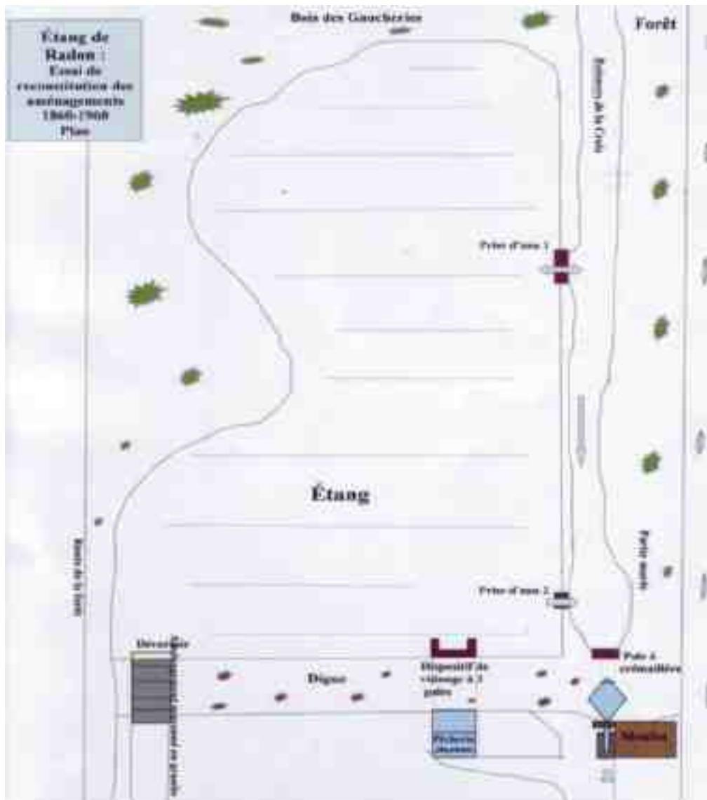
Figure 6. Plan de l'étang du moulin du Rocher, proposition de restitution.
