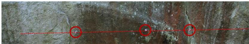
Un relevé au niveau de chantier fixe les grandes proportions et donne les hauteurs de la ligne de repère horizontal, de la hauteur du rocher et la distance à la base à partir d'un point repéré dans le carroyage. Ces mesures donneront autant de points de vérification du modèle 3D.
