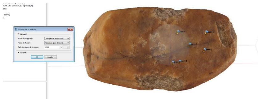
Le modèle a 10 000 face (simplification de 10%, c'est-à-dire que l'on est passé de 100000 à 10000 faces), maintient, grâce à la parfaite résolution de la texture, un aspect parfaitement défini. Il pourra être utilisé pour le temps réel.
