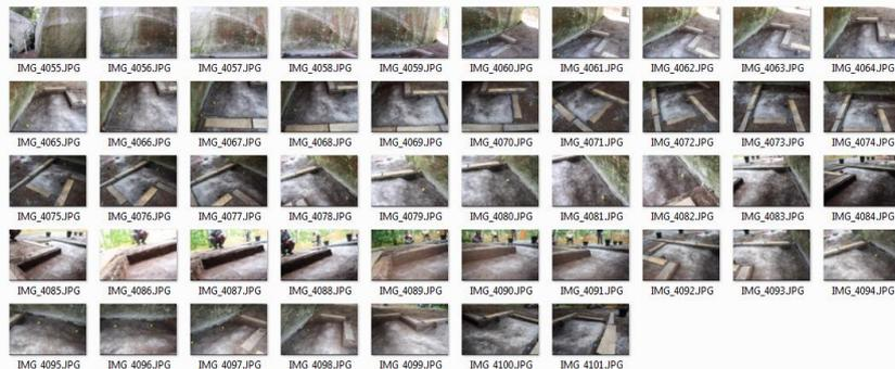
Dans Photoscan, il faut aller dans le menu « **traitements / Ajouter des photos** » et sélectionner l'ensemble des fichiers de la prise de vue. Le premier traitement consiste à Aligner les photos, il faut de nouveau aller dans « **Traitements / Aligner les photos...** »
