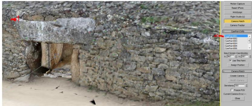
Une fois fait, il faut créer une caméra et le modèle est positionné dans la perspective de la photo.
