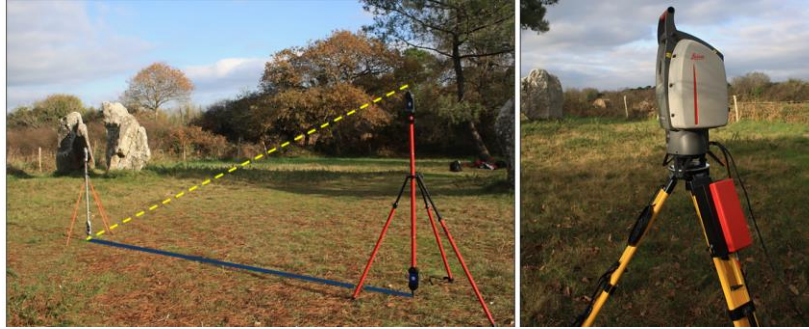
Figure 38 - Crucuno, relevé laser et vérification du nord géographique
