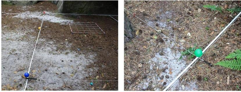
Des repères horizontaux positionnés grâce à un niveau laser sont fixés en ceinture sur le rocher.
