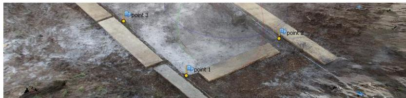
Pour créer une barre d'échelle, il suffit de sélectionner deux points puis cliquer « **Bouton Droit / Créer une barre d'échelle** », puis renouveler l'opération avec l'autre point.
