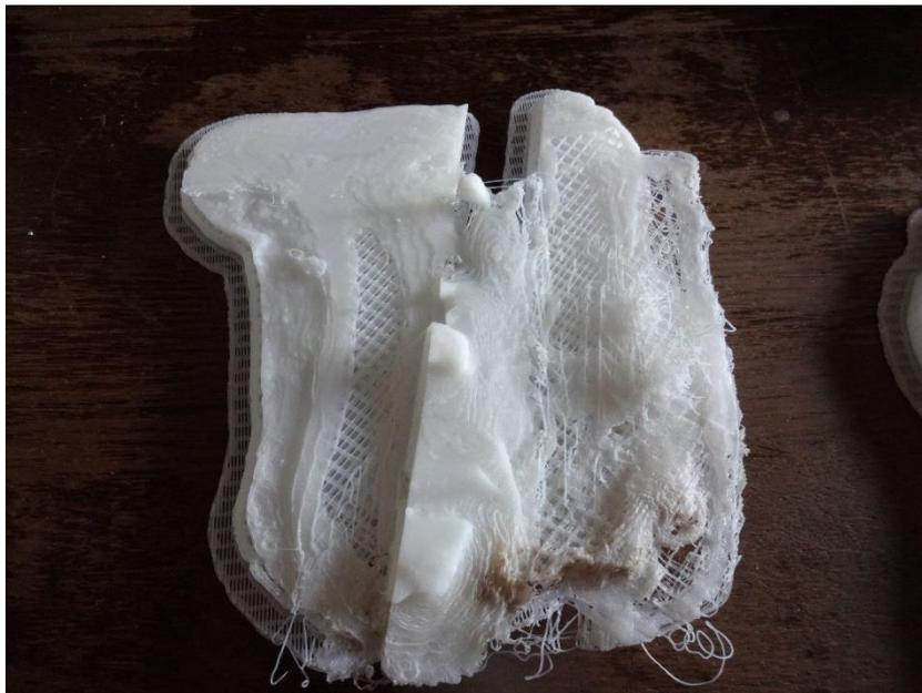
Cela est probablement dû à la température de la plaque, trop chaude. Ce type de géométrie est particulièrement redoutable pour ces imprimantes car il y a des bords fins, des creux et une grande surface plane. Toute déformation génère des erreurs qui pénalisent toute la suite du processus. Ici, le socle s'est probablement légèrement soulevé.
