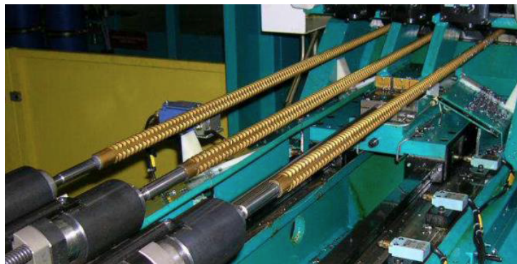
FIGURE 3.4 : Station de brochage composée de 3 broches travaillant simultanément
