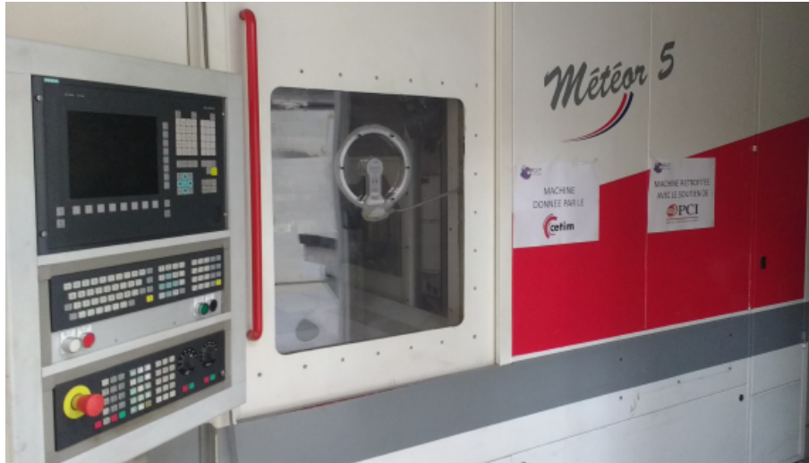
FIGURE 3.10 : Photo du centre d'usinage Météor 5 utilisé pour les essais de brochage
