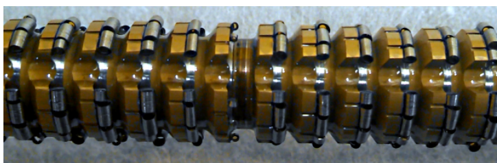
FIGURE 6 : Exemple de copeaux collés sur arêtes de coupe après brochage
