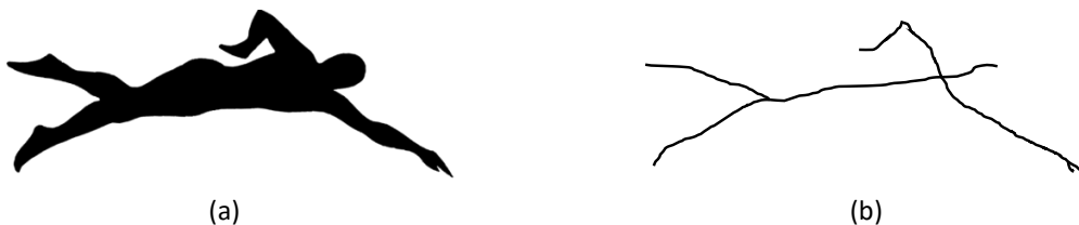
FIGURE 1.3 – Résultat de l'application de la technique thinning sur l'image binaire d'un nageur.
