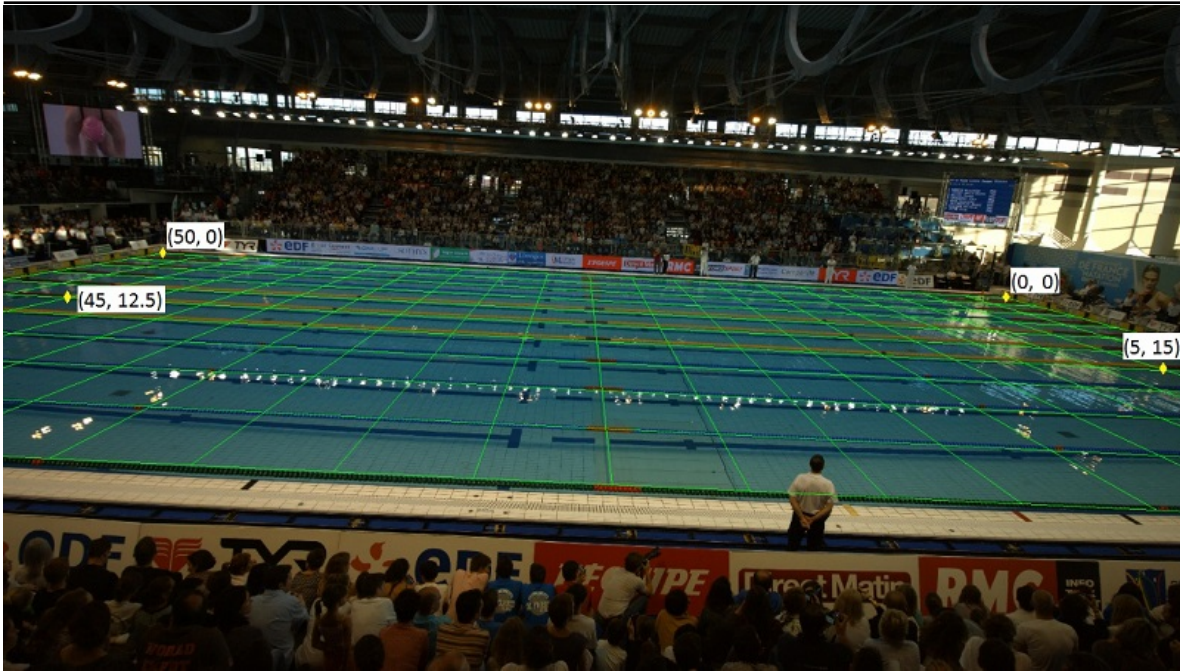
FIGURE 2.8 – Calibrage du bassin par la technique 2D DLT à partir de quatre points. Affichage d'une grille 50 \times 25 \text{ m}^2 où chaque cellule représente une zone de 2.5 \times 2.5 \text{ m}^2 . Championnats de France de Natation - Limoges, Avril 2015
