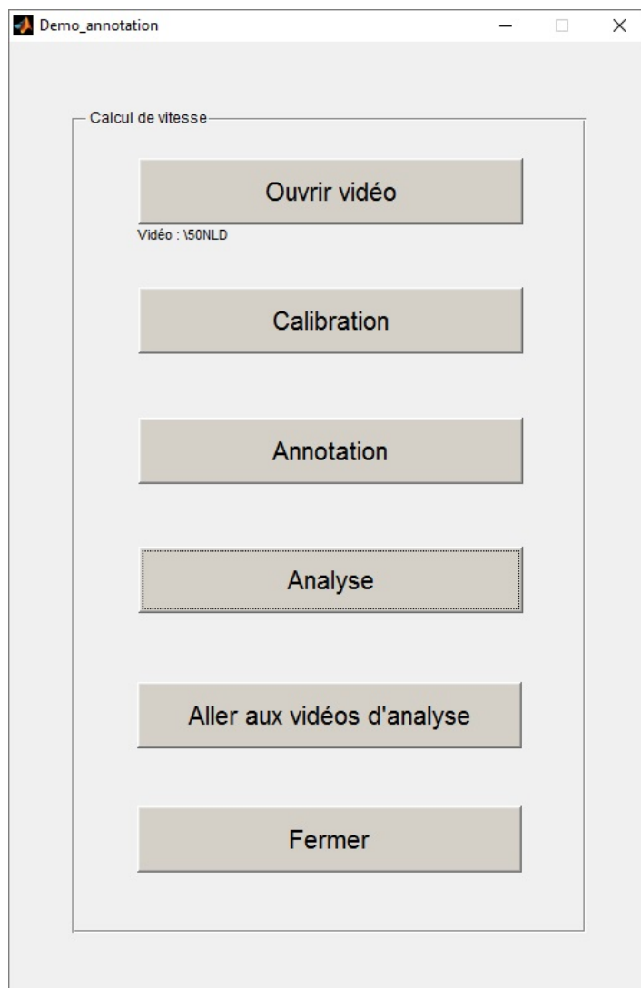
FIGURE A.1 – Interface graphique Matlab pour le calibrage, l'annotation des nageurs, le calcul de la vitesse et l'analyse des performances.
