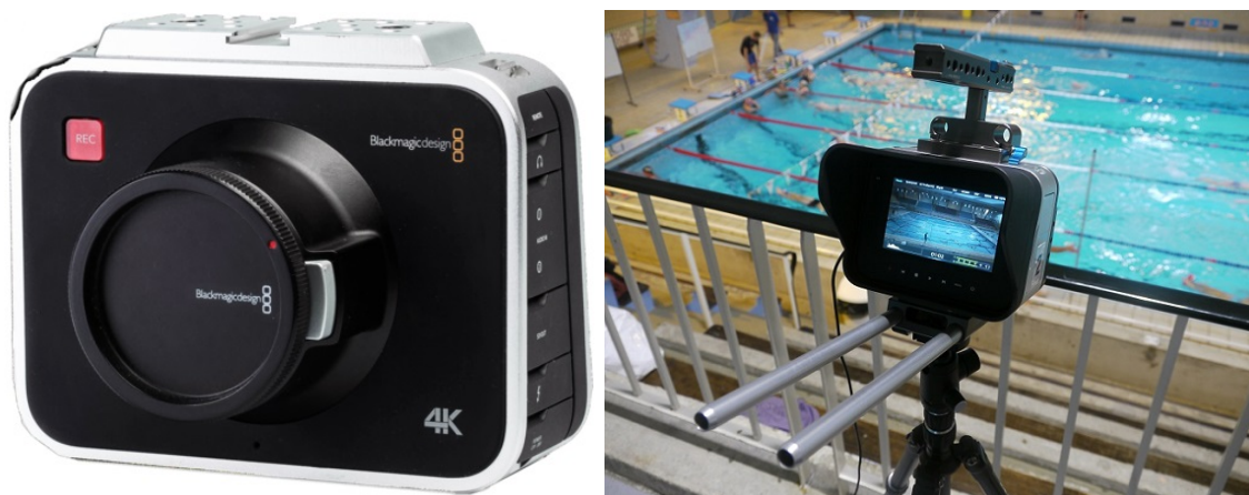
FIGURE 5.4 – Mise en place du système de prise de vue utilisant la caméra Blackmagic 4K dans les gradins de la piscine en condition de compétition. Championnat national de natation - Limoges, France 2015.
