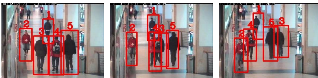
FIGURE 1.14 – Système de suivi de personnes basé sur la fusion des histogrammes de gradient orienté et les histogrammes de couleurs [11]. Exemple de suivi de personnes dans trois images successives prise par une caméra de surveillance. En rouge, les personnes détectées et le nombre affiché au dessus de la tête de chaque personne correspond à son identifiant.
