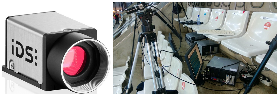
FIGURE 5.2 – Mise en place du système de prise de vue utilisant la caméra industrielle IDS dans les gradins de la piscine en condition de compétition. Championnat du monde de natation - Barcelone, Juillet 2013
