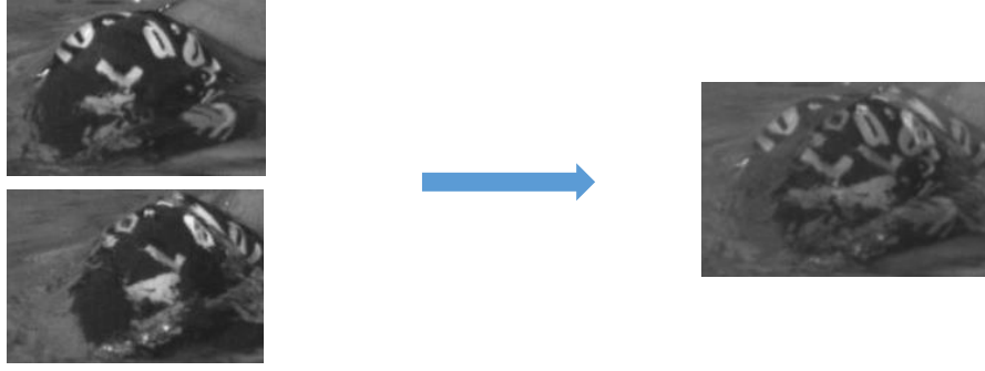
FIGURE 2.20 – Principe du filtre composite. A gauche : les images de référence. A droite : l'image composite qui consiste à une sommation pondérée des deux images de référence.
