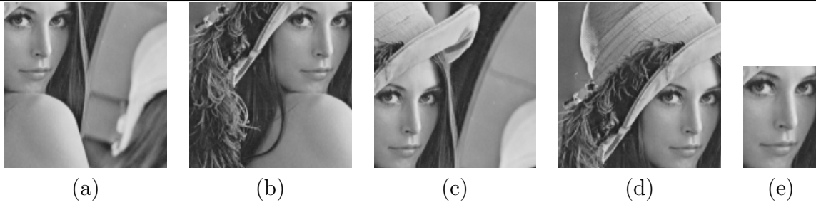
FIGURE 3.2 – Exemple d’images pouvant être utilisées pour localiser la zone potentielle de corrélation. (a) image cible pour le coin haut/gauche. (b) image cible pour le coin haut/droit. (c) image cible pour le coin bas/gauche, (d) image cible pour le coin bas/droit. (e) image de référence.
