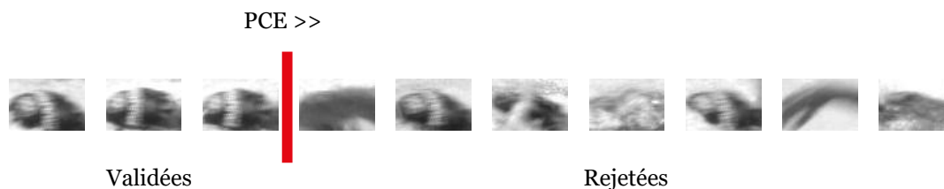
FIGURE 2.23 – Validation des détections potentielles selon un critère de décision basé sur le PCE. Les cibles détectées sont classées selon l'ordre décroissant de leurs valeurs de PCE. Les trois cibles potentielles validées sont celles ayant les plus hauts PCE. Championnats de France de Natation - Limoges, Avril 2015
