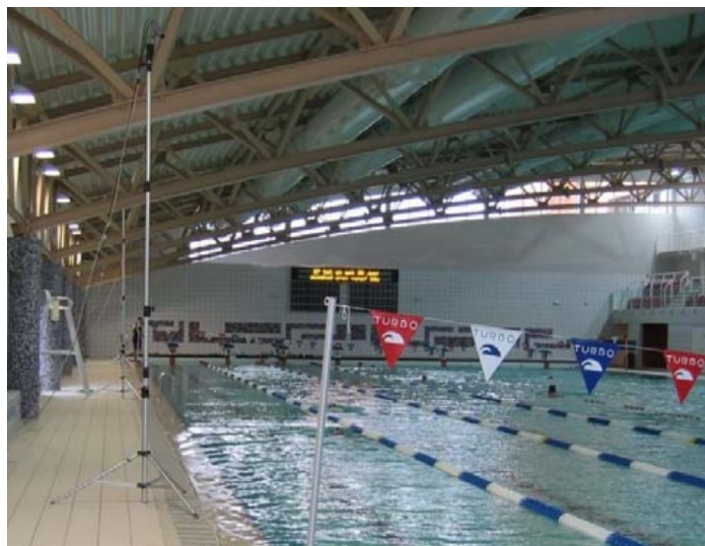
FIGURE 1.17 – Système d'enregistrement des vidéos d'entraînement. Trois caméras sont placées au bord du bassin sur des trépieds afin de permettre l'obtention d'une vue de dessus qui assure une meilleure analyse de performances.
