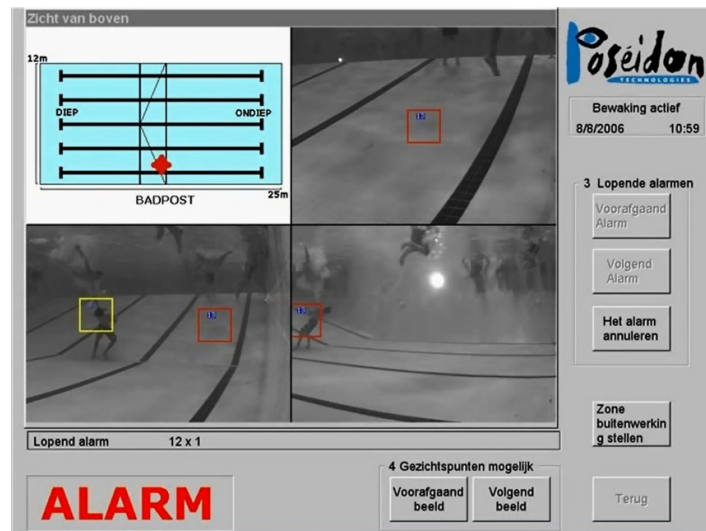
FIGURE 1.18 – Projet Poséidon pour la détection de noyade. Caméras étanches placées dans le fond du bassin permettant la détection des personnes qui dépassent un certain niveau de sécurité (noyade).
