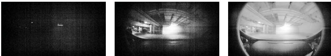
FIGURE II.47 – Manifestation du Fixed Pattern Noise dans les images prises dans un espace sombre. Mise en évidence du phénomène à travers une variation du paramètre gamma et de la désactivation de la correction
