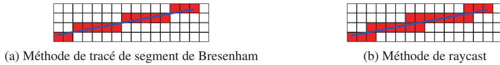
FIGURE IV.2 – Méthodes de remplissage de la grille d'occupation
