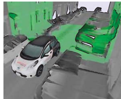
(b) Cartographie 3D utilisant un LiDAR installé en plan vertical
