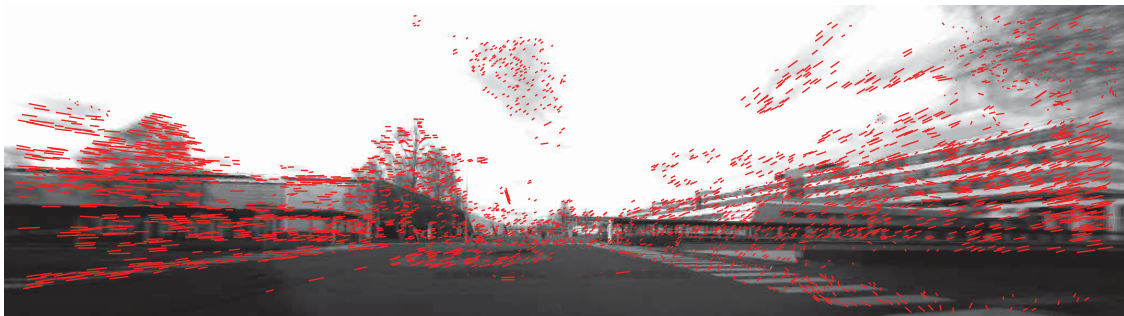
FIGURE IV.26 – Appariement des points entre deux images. Les segments rouges indiquent les directions de déplacement des points d'intérêts détectés dans deux images successives du flux vidéo enregistré pendant le déplacement du véhicule
