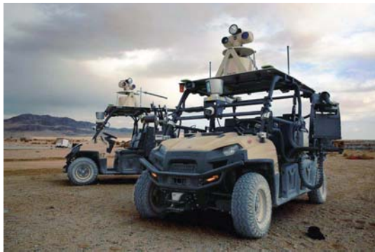
(a) Flotte de robots mobiles General Dynamics MDAR en patrouille sur le site de NNSS [Czapla and Wrona, 2013]
