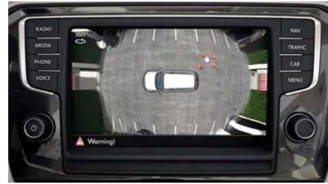
(b) Vue 360° autour de la voiture réalisé par synthèse d'images issues de 4 caméras grand angle ( birdview )
