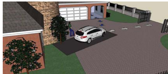
(b) Conduite automatique vers la zone de reprise du véhicule (trajectoire bleue) puis conduite manuelle (trajectoire blanche)
