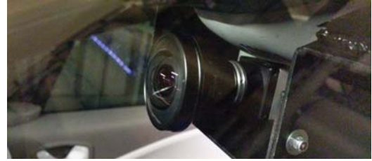
FIGURE II.56 – Emplacement et fixation de la caméra dans l'habitacle (derrière le pare-brise)
