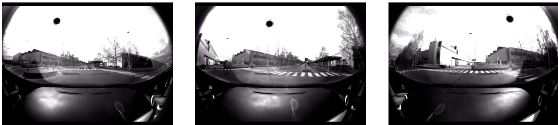
FIGURE II.48 – Compensation de contre-jour : détection et isolement des sources de forte illumination (comme le soleil)
