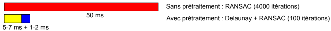
FIGURE IV.38 – Comparaison du temps de calcul pour les deux approches RANSAC sans puis avec utilisation d'une étape de prétraitement d'élimination d'outliers par la méthode de Delaunay ; en jaune est illustré le temps de calcul utilisé dans l'étape de prétraitement par la méthode Delaunay ; en bleue est désigné le temps de calcul utilisé par l'algorithme RANSAC utilisant uniquement 100 itérations
