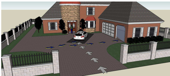
(a) Conduite manuelle vers la place de parking (trajectoire blanche) puis évolution automatique du véhicule dans le garage (trajectoire bleue)
