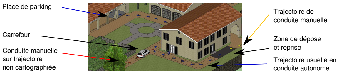
FIGURE I.21 – Cas d'utilisation du voiturier autonome avec possibilité d'activation du système depuis une position non apprise (cas de multiples trajectoires)
