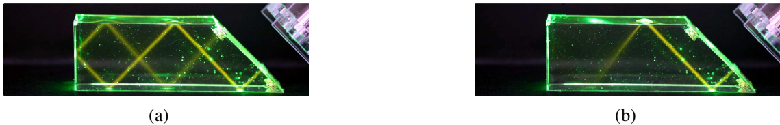
FIGURE II.61 – Détecteur de pluie : Par temps sec le rayon est réfléchi dans le bloc optique (figure (a)), en revanche par temps de pluie, une partie de la lumière se réfracte (sort du bloc) en passant par la goutte d'eau (figure (b))
