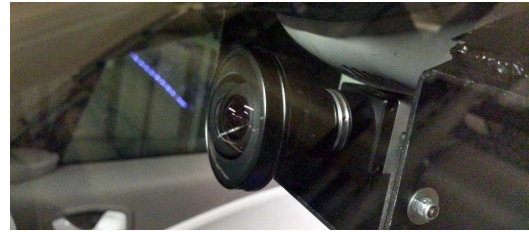
FIGURE II.56 – Emplacement et fixation de la caméra dans l’habitacle (derrière le pare-brise)
