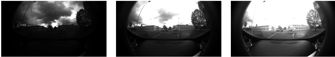
FIGURE II.46 – Amplification du signal de l'image par augmentation du gain
