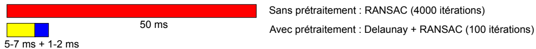
FIGURE IV.38 – Comparaison du temps de calcul pour les deux approches RANSAC sans puis avec utilisation d'une étape de prétraitement d'élimination d'outliers par la méthode de Delaunay ; en jaune est illustré le temps de calcul utilisé dans l'étape de prétraitement par la méthode Delaunay ; en bleue est désigné le temps de calcul utilisé par l'algorithme RANSAC utilisant uniquement 100 itérations
