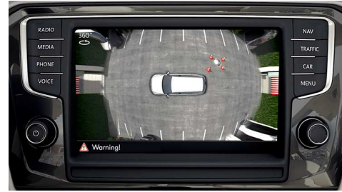
(b) Vue 360° autour de la voiture réalisé par synthèse d'images issues de 4 caméras grand angle ( birdview )
