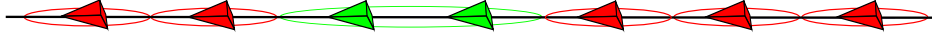
FIGURE III.41 – A chaque position sur la trajectoire de référence nous assignons une incertitude de positionnement suivant la ressemblance des images dans son voisinage. A titre d'exemple, pour les deux images vertes qui se ressemblent l'ellipse d'incertitude est centrée sur le barycentre et englobe les deux positions
