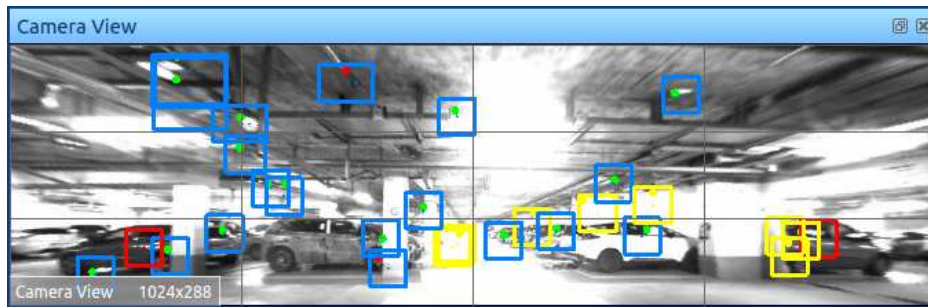
FIGURE III.16 – Détection et suivi des points d'intérêt dans plusieurs images successives. Les rectangles englobants des points d'intérêt ont une couleur en fonction du niveau de la précision de la position 3D du point correspondant : rouge pour les points les plus incertains, puis bleu, terminant par la couleur jaune pour les points ayant atteint la précision requise pour que le point soit stocké dans la carte. Enfin, si un point n'a pas atteint le niveau «jaune» avant de disparaître du champ de vue, il sera rejeté et un autre point d'intérêt coloré en magenta le remplacera
