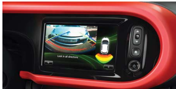
FIGURE II.26 – Interface R-Link de Renault Twingo - détection d'obstacle utilisant le système de capteurs ultrason et visualisation d'obstacles utilisant une caméra de recul
