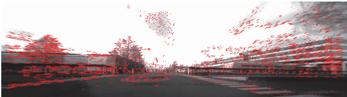
FIGURE IV.26 – Appariement des points entre deux images. Les segments rouges indiquent les directions de déplacement des points d'intérêt détectés dans deux images successives du flux vidéo enregistré pendant le déplacement du véhicule
