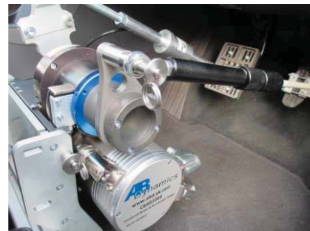
(b) Robot de conduite AB Dynamics [Ambrus et al., 2013; Praveen Kumar Peter, 2013]
