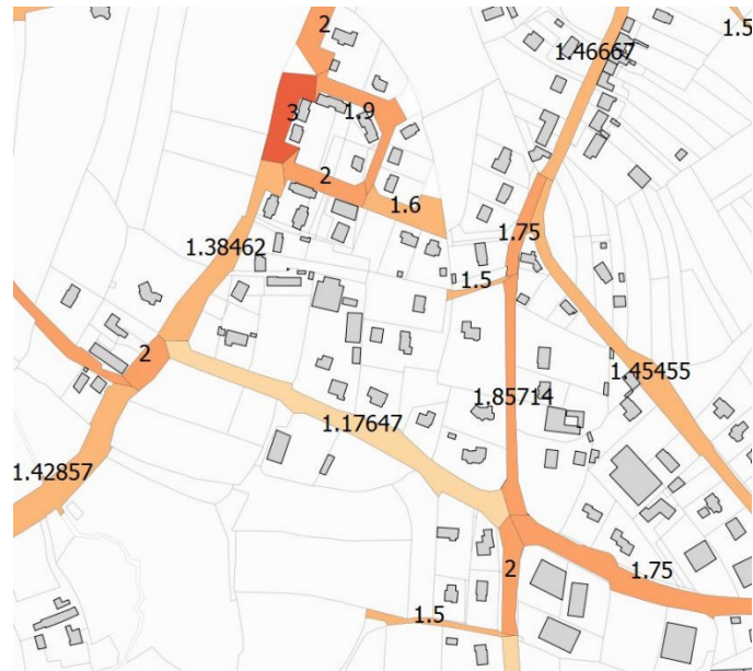
Figure 40 : Mesure de connectivité locale du bâti
