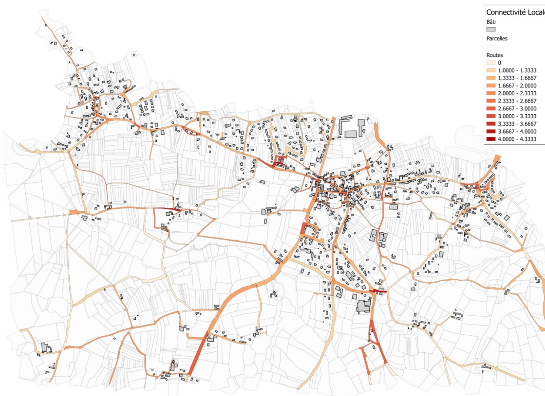
Figure 39 : Mesure de connectivité locale du bâti
