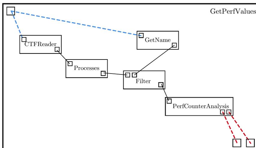
FIGURE 6.5 – Détail du sous-workflow `GetPerfValues`
