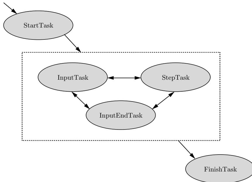
FIGURE 5.11 – Automate à états représentant l'exécution d'un module
