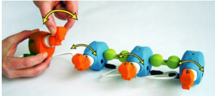
FIGURE 14 – Principe de programmation tangible dans Topobo (RAFFLE, 2008).
