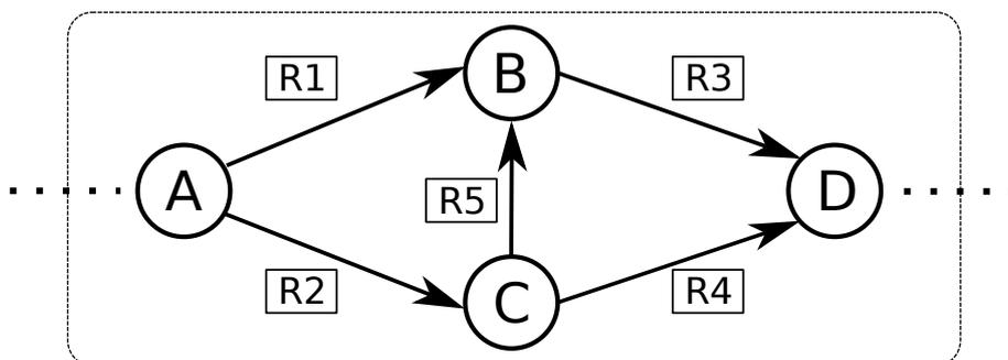
FIGURE 3.1: Réseau d'exemple pour le calcul de chemins indépendants
