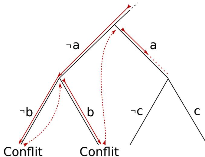
FIGURE 1.10: Illustration du fonctionnement d'un solveur DLL
