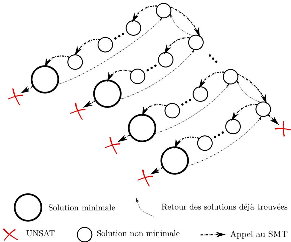
FIGURE 4.4: Déroulement schématique d'une minimisation « totale »
