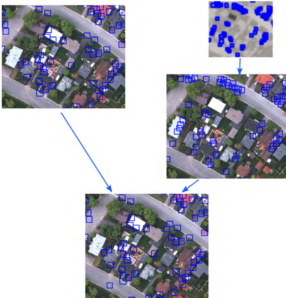
FIGURE 4.7 – Illustration de la fusion entre les hypothèses de détection du domaine optique et du domaine infrarouge. Les hypothèse de détection du domaine infrarouge sont projetées dans le domaine optique puis la fusion grâce à la NMS est effectuée.
