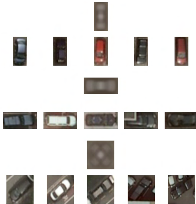
FIGURE 3.12 – Partitionnement des exemples de la base Christchurch en 3 sous-catégories pour la classe voiture. Pour chacune des sous-catégories nous avons d’abord affiché l’image moyenne de la sous-catégorie pour visualiser globalement la variation d’apparence puis 5 exemples tirés aléatoirement dans la sous-catégorie.
