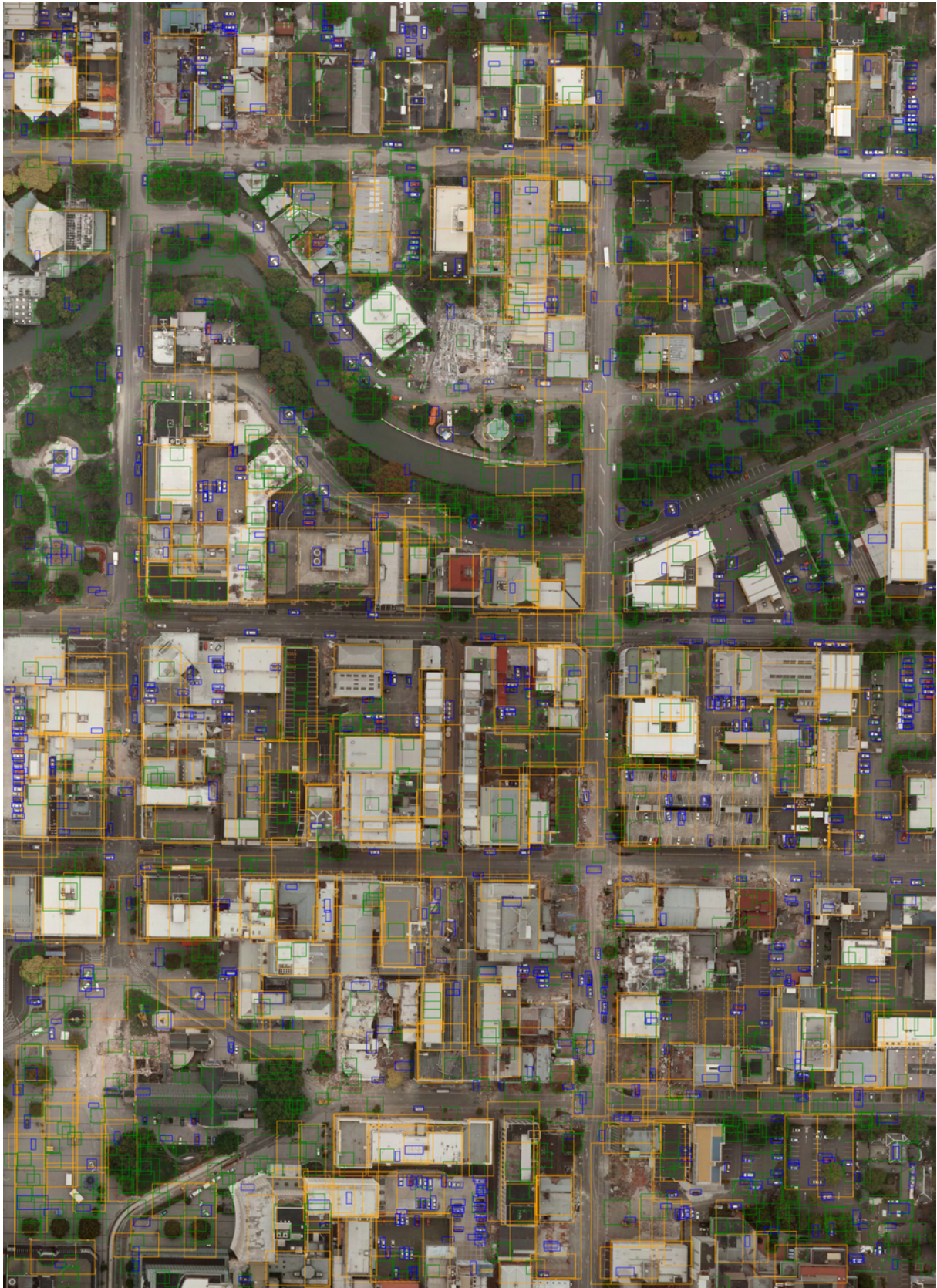
FIGURE 4.10 – Détections du DtMM sur l'image de test de la base Christchurch. Les détections de voiture sont en bleu, celles de bâtiments sont jaune et celles de végétation en vert. On observe que d'un point de vue global le détecteur arrive à reconnaître les objets des différentes catégorie même si il est peu précis dans le cas des bâtiments et des arbres.
