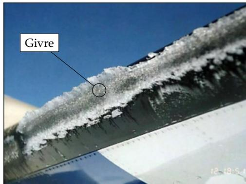
(a) Accrétion de givre sur le bord d'attaque d'une aile.
