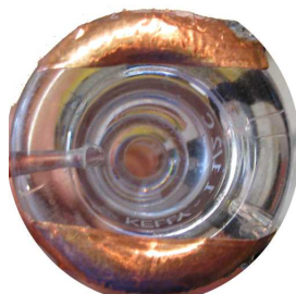
FIGURE 7.4 – Électrodes de l'ÉlectroLabioGraphe collées à l'embouchure : chaque contact en cuivre est en contact avec une lèvre du musicien. Les électrodes ont été plaquées à l'argent par la suite.
