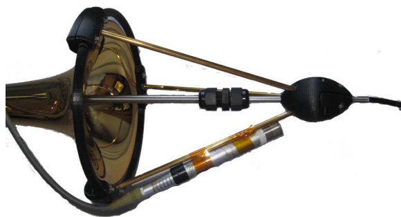
FIGURE 7.5 – Support du microphone de mesure de la pression rayonnée (en bas) et de l'anémomètre (tige centrale rentrant dans le pavillon).
