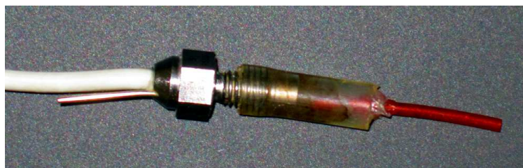
FIGURE 7.2 – Montage des microphones miniatures Endevco. Le capteur est la partie métallique sur la gauche, le capillaire rouge entre soit dans un trou pratiqué dans la cuvette de l'embouchure, soit à la commissure des lèvres du trompettiste. Le tuyau en silicone transparent assure la jonction étanche.
