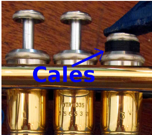
FIGURE G.4 – Étalonnage des capteurs de position des pistons. La course du piston est maintenue à l'aide d'un serrage et de cales d'épaisseur enfilées sur l'axe du piston.
