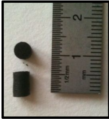
Bioélectrodes après compression : cylindres de 5 mm de diamètre et 6 mm de long
