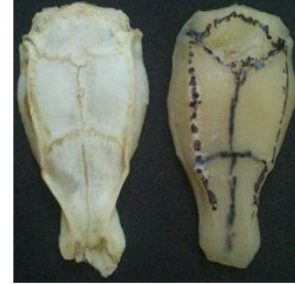
Os du crâne de rat et moule en résine photo polymérisable
