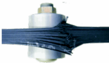
FIGURE – Délaminage autour d'un boulon.
