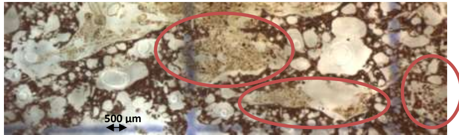
Figure 61 - Colmatage progressif de vides intra-particulaires (vésicules) par des particules fines et notamment de la matière organique (point de prélèvement 3)
