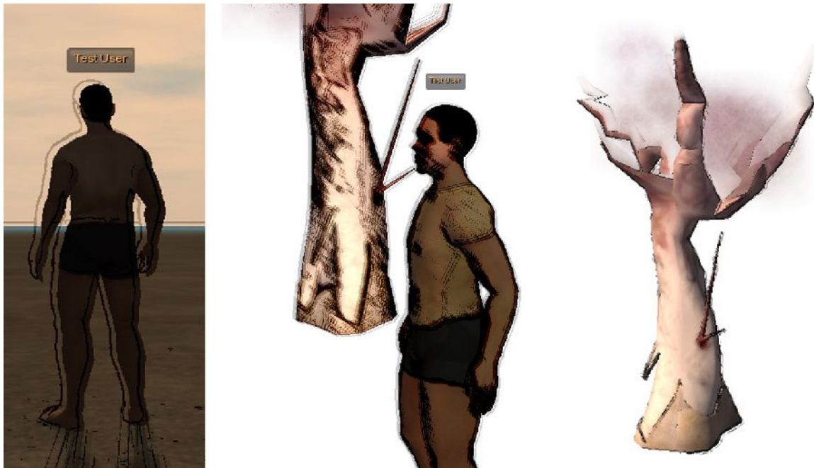
Figure 68 : Captures d'écran des évolutions du shader de contour dans realXtend . De gauche à droite, un seul contour décalé ; trois contours, dont deux décalés ; trois contours ondulés suivant une fonction sinus et dont l'intensité varie en fonction d'une texture.
