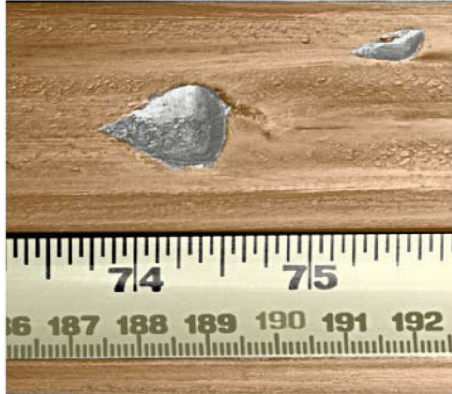
FIGURE 1.9 – Phénomène de gouging observé à l'interface de matériaux mis en glissement à l'aide d'un canon à rail. Observations de F.STEFANI et J.PARKER (voir [48])
