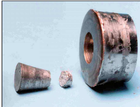
FIGURE 1.12 – Aperçu post-mortem de la cible après impact.
