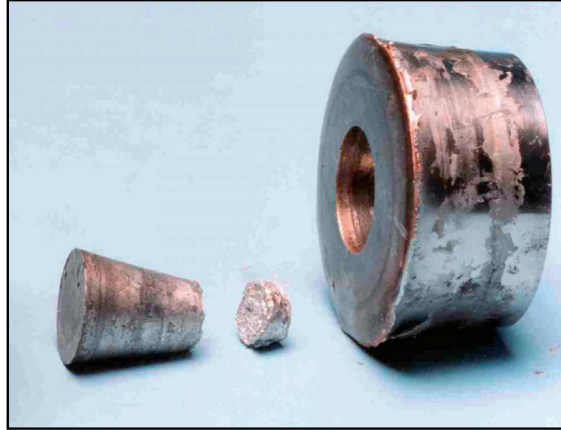
FIGURE 1.12 – Aperçu post-mortem de la cible après impact.
