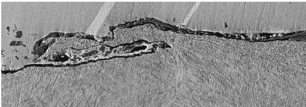
FIGURE 1.10 – Illustration d'une MML'S "Mechanically Mixed Layers". L'échauffement observé aux interfaces de glissement conduit dans certains cas à la miction partielle des interfaces (voir [45]).
